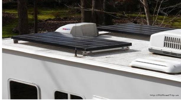
Figura 1.11. Panel solar instalado en una autocaravana.
