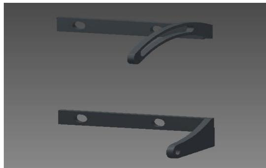
Figura 3.27. Diseño final del soporte inferior.
