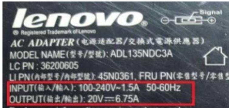
Figura 2.3. Especificaciones de corriente entrada y salida laptop.
