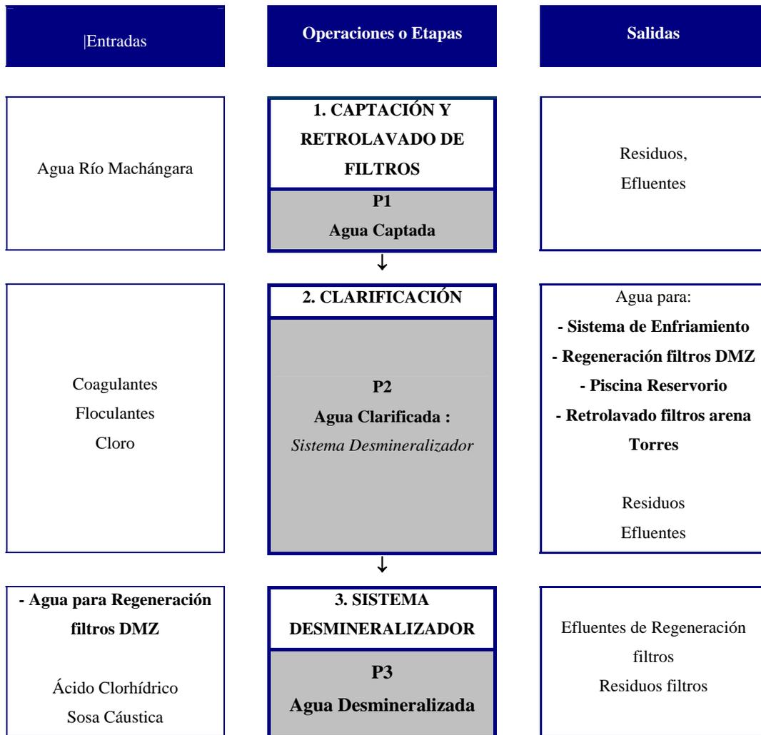
Fig. 1 Ejemplo de Diagrama de flujo
