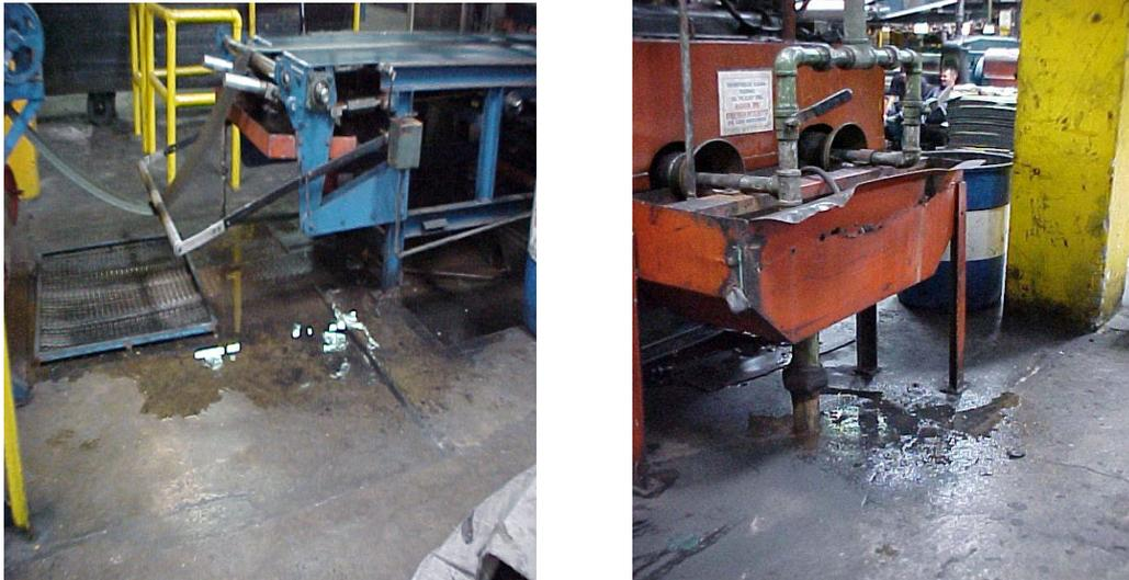
**Fig. 17** Fugas Extrusora
