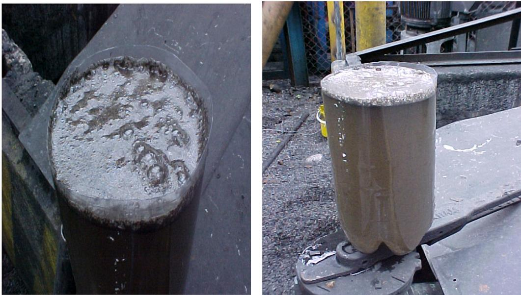
**Fig. 21** Agua del pozo de la Torre de Enfriamiento. Flora Bacteriana en forma de capa sobre el agua
