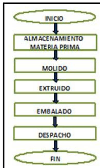
**Figura 10. Proceso productivo de perfiles siliconados para hornos de cocina**
