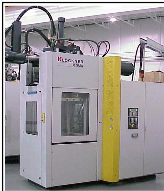
**Figura 23. Inyectora Desma 968.400ZO**
