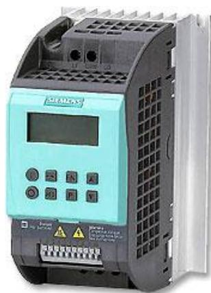
Fig. 1.24. Controlador para ventilador.
