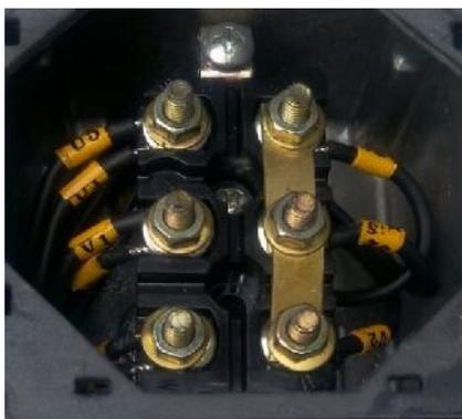
Fig. 2.42 Conexión Doble Estrella.
