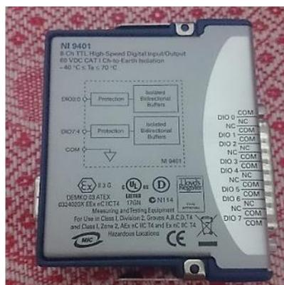
Fig. 1.27. Módulo DAQ NI9401.
