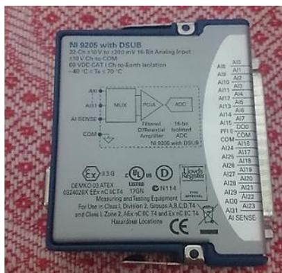
Fig. 1.26. Módulo DAQ NI9205.
