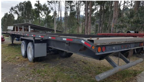
Figura 2.9 Plataforma para el traslado de los miembros estructurales
