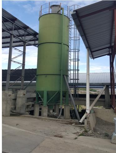
Figura 2.3 Equipos para el almacenamiento y la dosificación de los áridos
