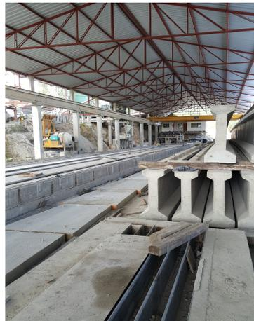
Figura 2.1 Bancadas, moldes fijos para la elaboración de vigas y losas
