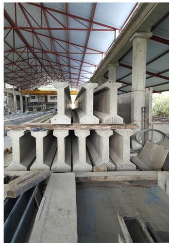
Figura 2.12 Almacenamiento de vigas tipo I, destinadas a utilizarse en el proyecto de movilidad Tranvía en la ciudad de Cuenca
