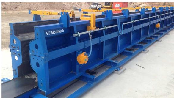
Figura 2.6 Encofrados de acero para vigas pretensadas prefabricadas tipo I
