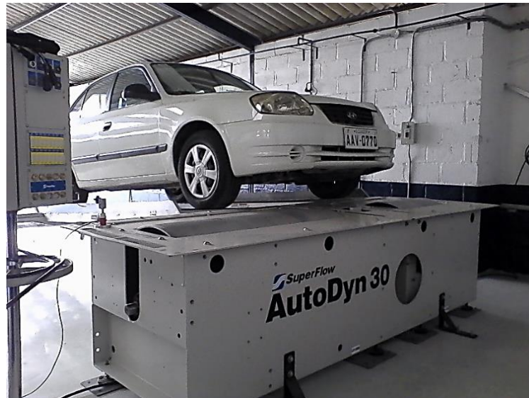
Figura 3.8: Hyundai Accent 2005 preacondicionado para las pruebas coastdown .
