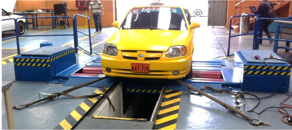
Figura 3.16: Sujeción del vehículo.
