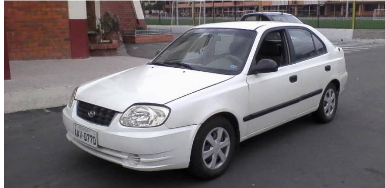
Figura 3.6: Hyundai Accent 2005 preacondicionado para la prueba de Coastdown .
