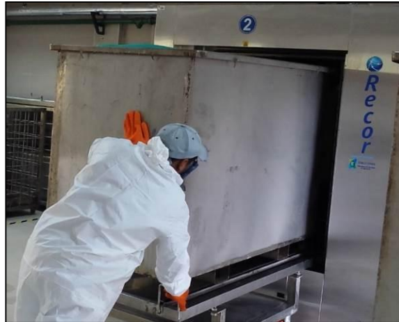
Figura 20. Ingreso de Rack a Cámara de Autoclave.
