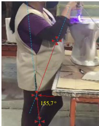
Figura 102: Reparadora de taza - Ángulo de flexión del antebrazo derecho
