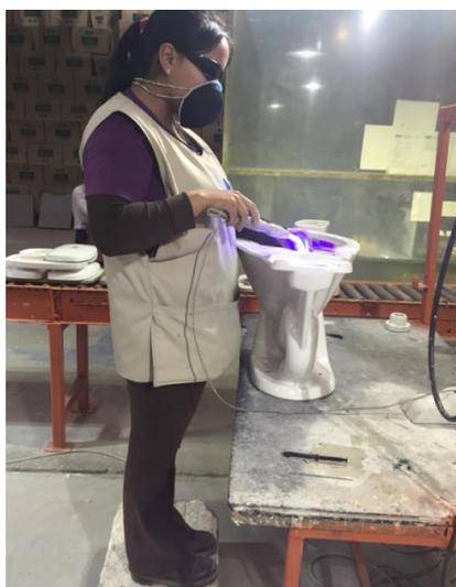
Figura 108: Reparadora de taza - Postura corregida al secar la resina con la lámpara de fotocurado
