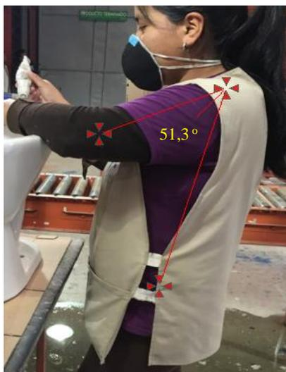
Figura 105: Reparadora de taza - Ángulo de flexión del brazo izquierdo
