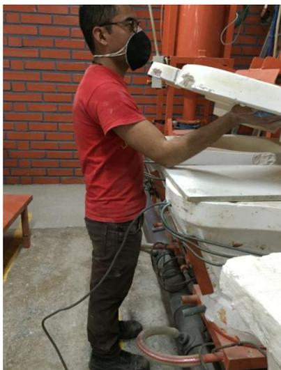
Figura 26: Ayudante de colado - Postura corregida al colocar talco y vaselina en el núcleo del molde
