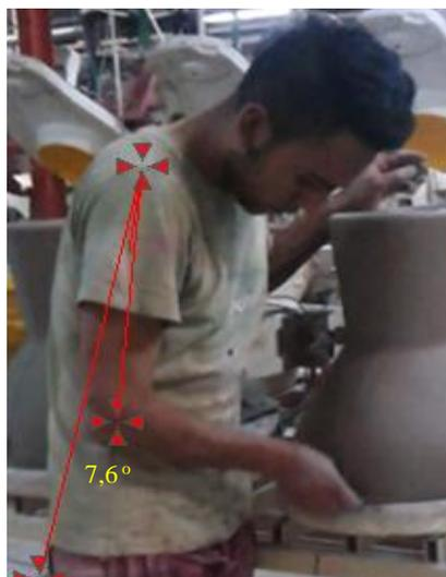
Figura 13: Colador de taza - Ángulo de flexión del brazo derecho-postura corregida
