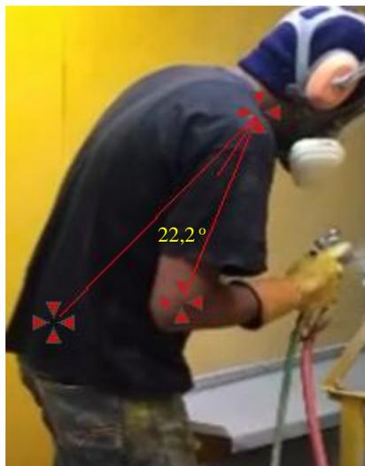
Figura 61: Esmaltador de taza - Ángulo de flexión del brazo derecho
