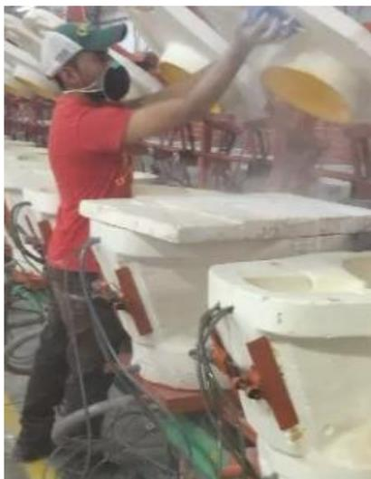
*Figura 19:* Ayudante de colado - Postura a evaluar al colocar talco y vaselina en el núcleo del molde
