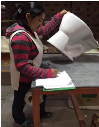
*Figura 79:* Clasificadora de taza - Postura a evaluar al identificar defectos en la taza
