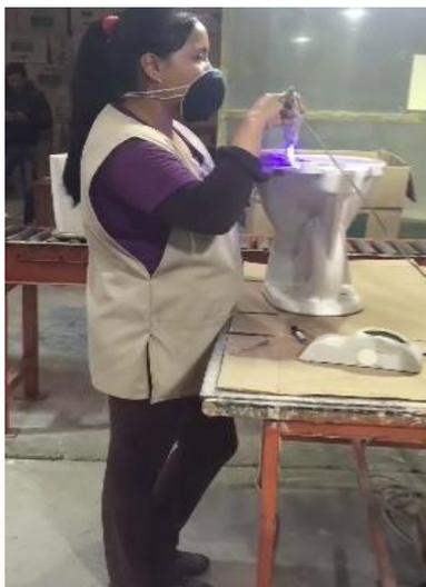
*Figura 98:* Reparadora de taza - Postura a evaluar al secar la resina con la lámpara de fotocurado
