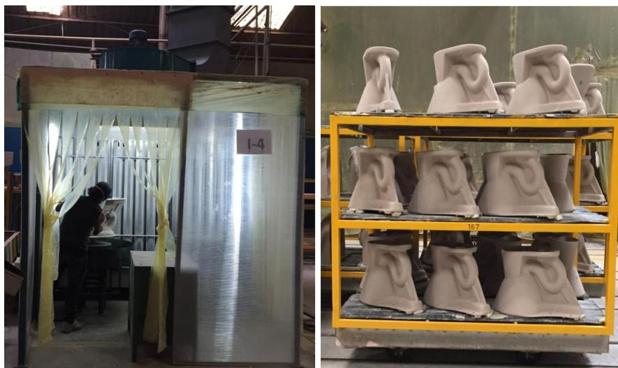
*Figura 31:* Inspección en Crudo - Cabina de inspección y coche de tres pisos
