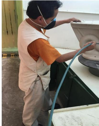
Figura 55: Abastecedor de taza - Postura corregida al sopletar la taza
