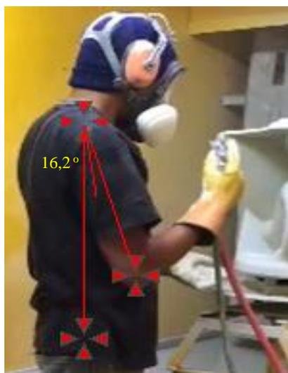
*Figura 66:* Esmaltador de taza - Ángulo de flexión del brazo derecho-postura corregida
