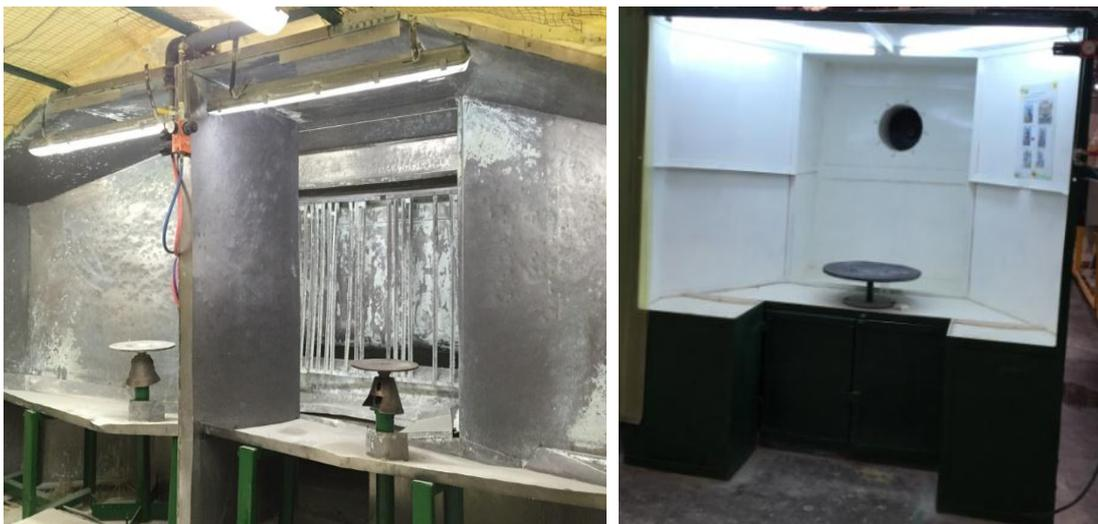
*Figura 44:* Esmaltación - Cabina de esmaltado y Cabina de inspección
