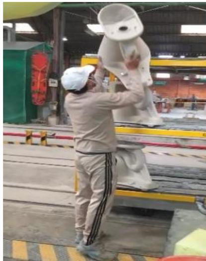
*Figura 32:* Inspector de taza - Descargar y cargar tazas al coche
