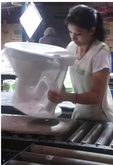
Figura 78: Clasificadora de taza - Levantar taza del conveyor
