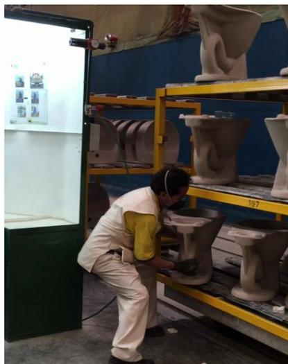
*Figura 45:* Abastecedor de taza - Descargar la taza inspeccionada desde el coche
