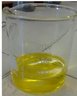
Figura 2. 3: Muestra de aceite de linaza obtenida por método Soxhlet
