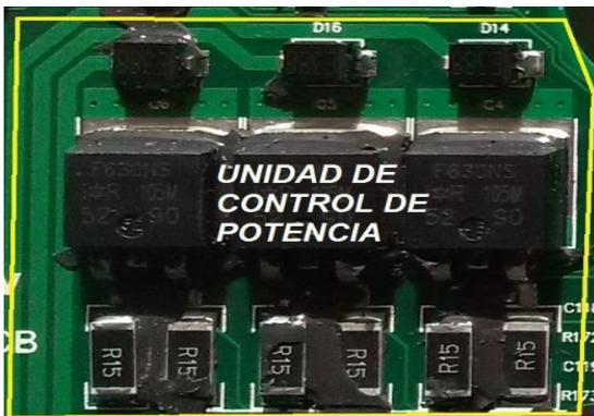
Figura 2.2.Unidad de control de potencia de ECU
