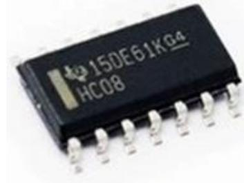
Figura 2.21. Compuerta lógica AND HC08.
