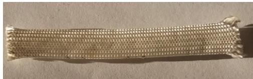
Figura 2.44. Almohadilla aislante de temperatura y electricidad.
