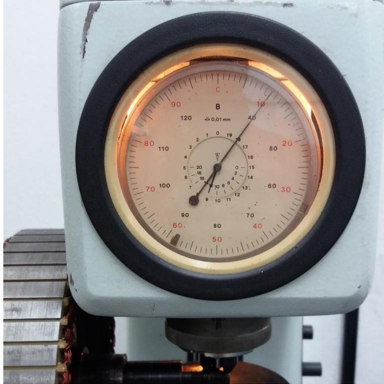
Figura 2.50. Medición de dureza en el Eje principal.
