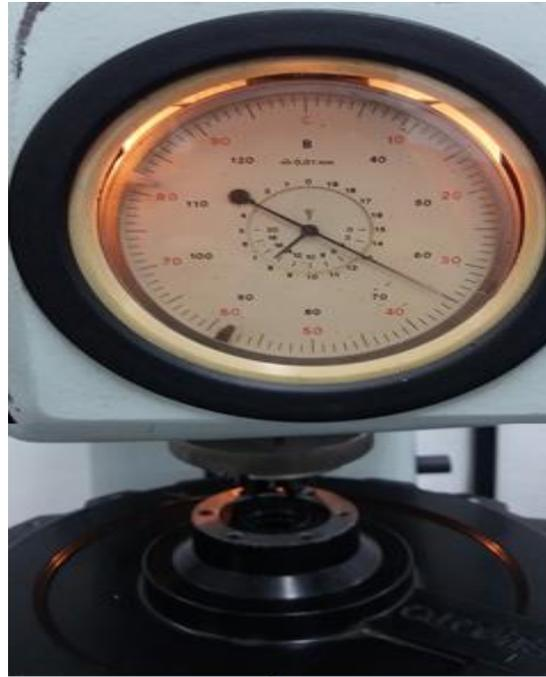
Figura 2.55. Medición de dureza en la carcasa del motor eléctrico.
