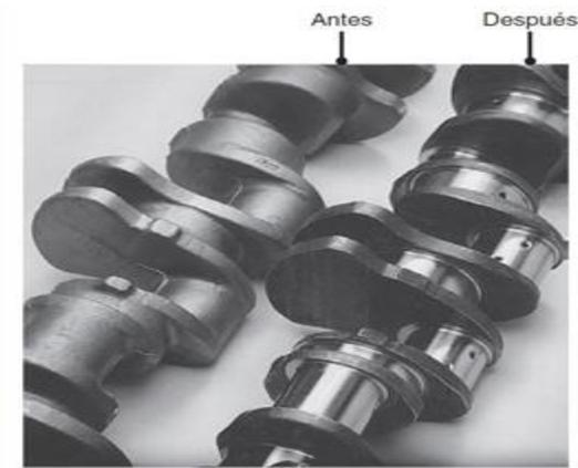
Figura 3.13. Cigüeñal forjado antes y después de maquinarse.
