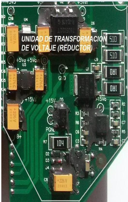
Figura 2.16. Unidad de transformación de voltaje en PCB.
