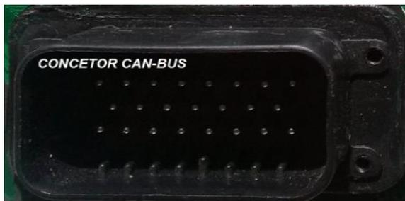
Figura 2.37. Conector de CAN-BUS
