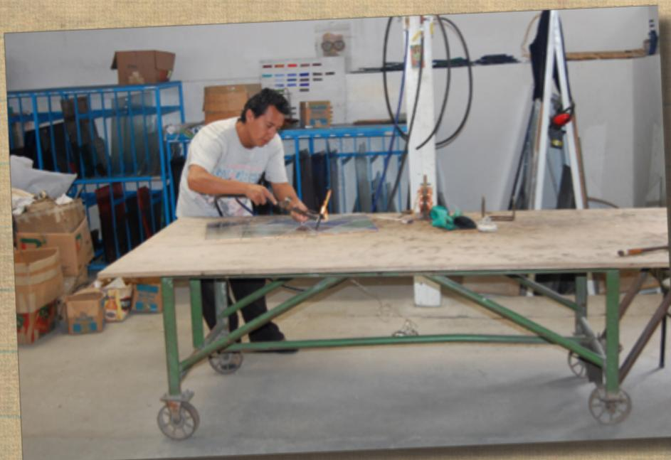
*Proceso de suelda y armado de paneles*
