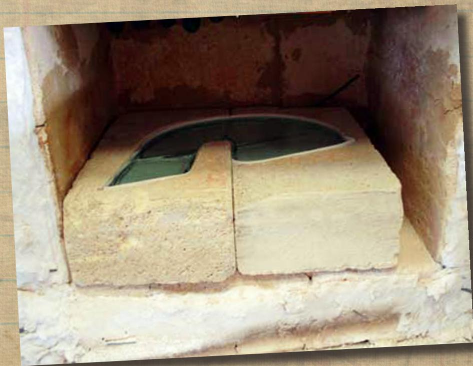
Uso de moldes de ladrillo refractario para vitrofusión
