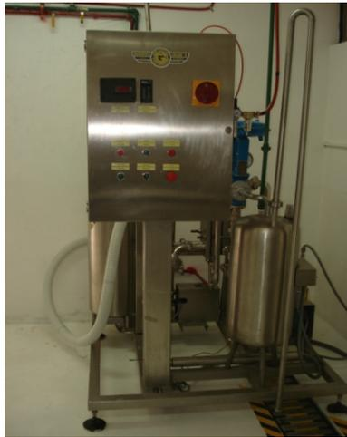
Fotografía 4.1 **Equipo de pasteurización** (fuente: foto tomada de los laboratorios de lácteos de la Universidad del Azuay)
