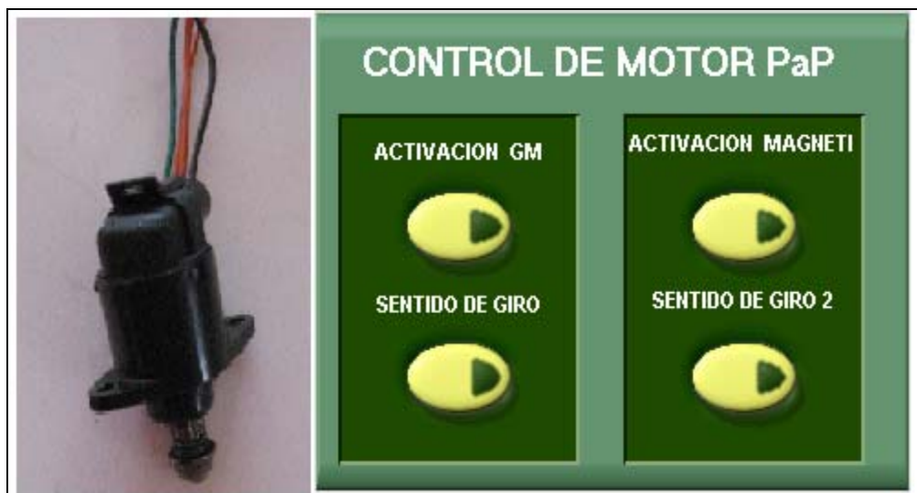
Fig. 5-32 Evaluación control del Motor paso a paso
