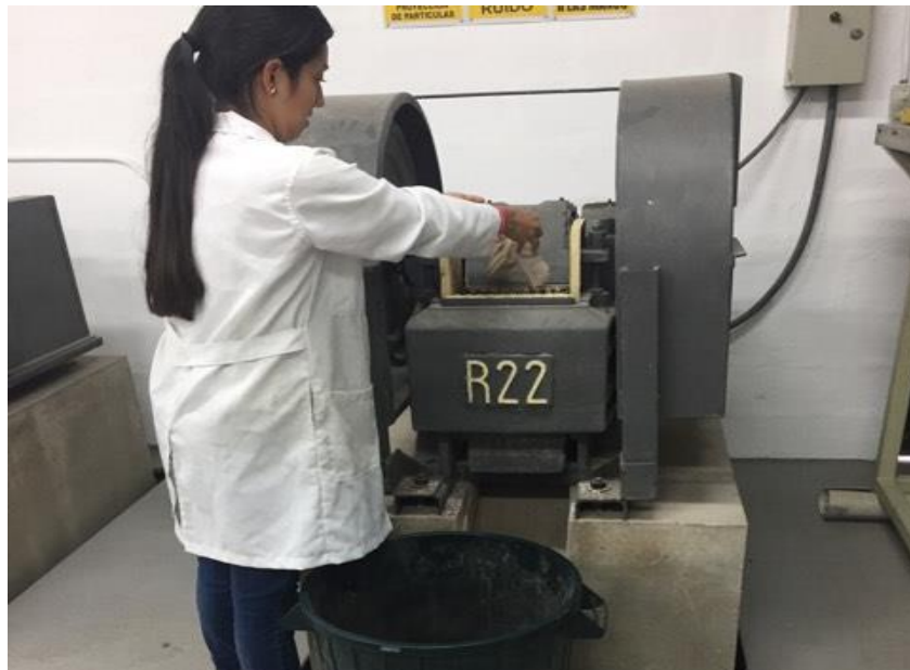
Figura 5.11 Trituración de material.
