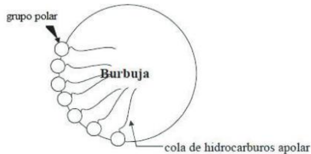
Figura 1.2 Adhesión de mineral a la burbuja.
