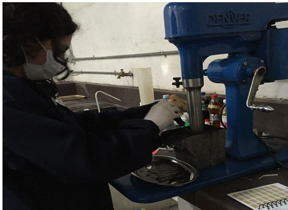
Figura 5.13 Proceso de flotación.
