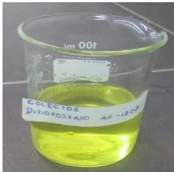
Figura 2.7 Colector ditiofosfato AR-1208.
