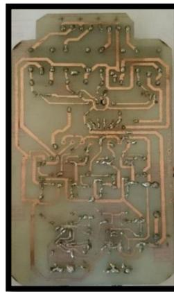
Figura 55 Rotulado de la placa en la baquelita
