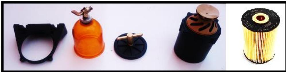
Figura 39 Partes y elementos del filtro de combustible
