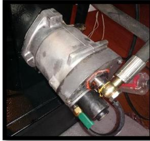
Figura 45 Bomba de alta presión.
