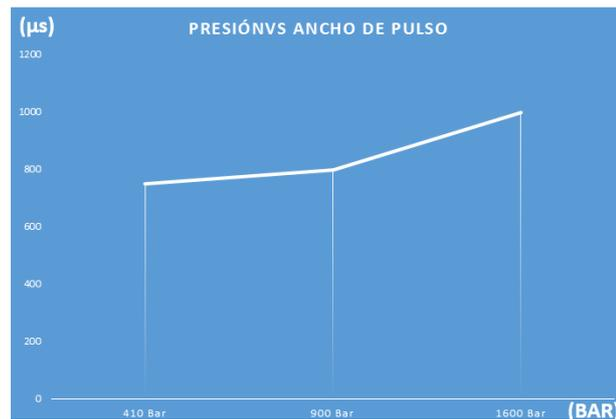
Figura 77 Presión en el riel vs ancho de pulso
