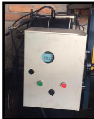
Figura 72 Botón de encendido (verde) máquina de simulación
