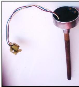
Figura 43 Medidor de combustible
