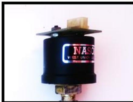
Figura 42 Switch de vacío del sistema didáctico
