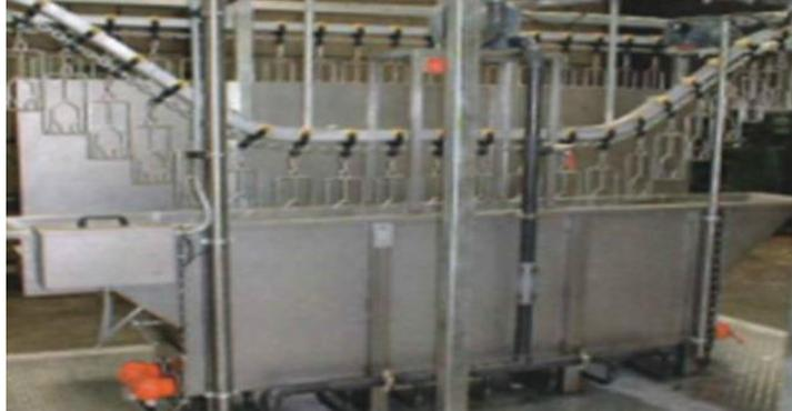
Figura 2.12: Escaldadora eléctrica con sistema de agitación de agua.
