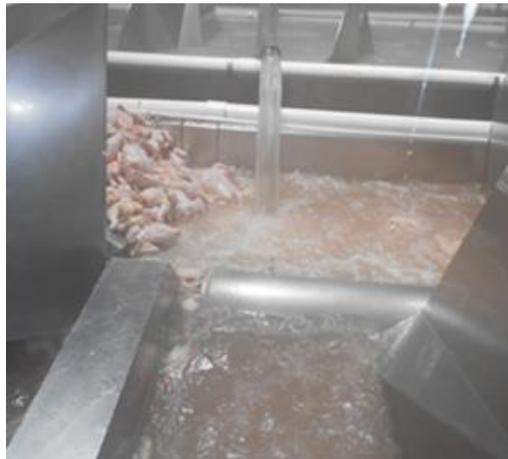
Figura 2.17: Enfriado de canales por inmersión en chiller
