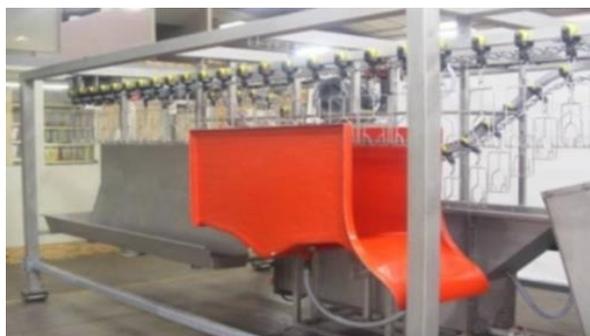
Figura 2.10: Aturdidor de baño eléctrico
