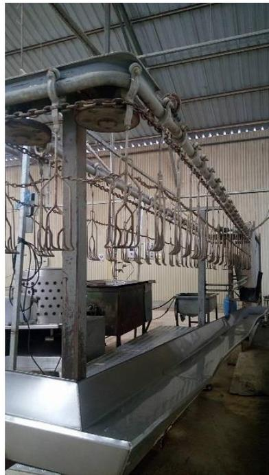
Figura 1.4: Aturdidor y canal de desangrado.
