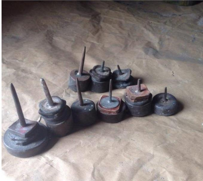
**Ilustración 45** Puntillas de Diferentes Diámetros Fuente: Autor
