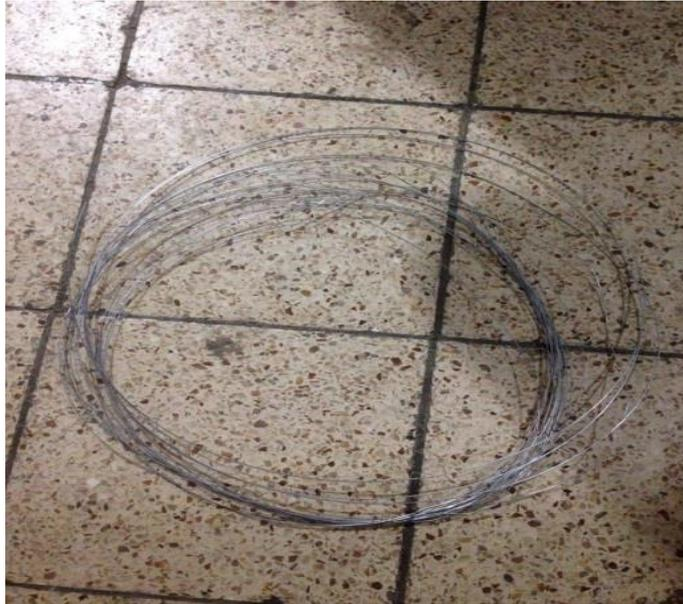
**Ilustración 39 Alambre Galvanizado # 22 Fuente: Autor**
