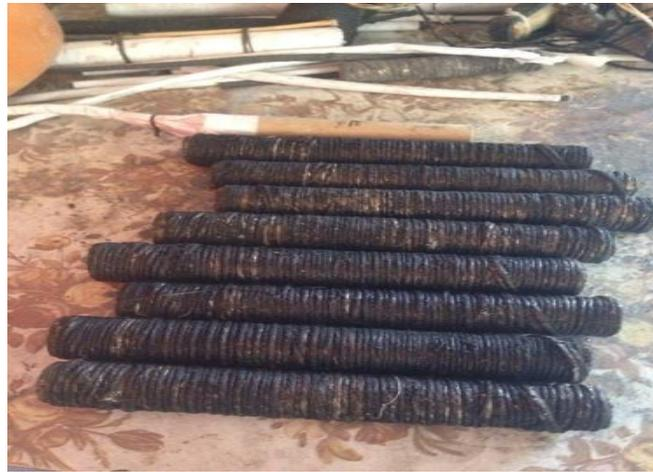
**Ilustración 75 Tiros que van colocados en la Carga de la Vaca Loca Fuente: Autor**
