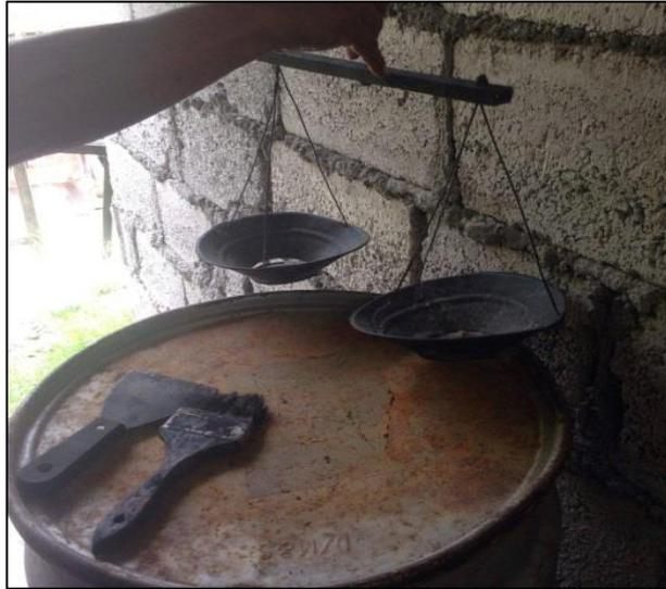
**Ilustración 50 Balanza de Dos Platos Fuente: Autor**
