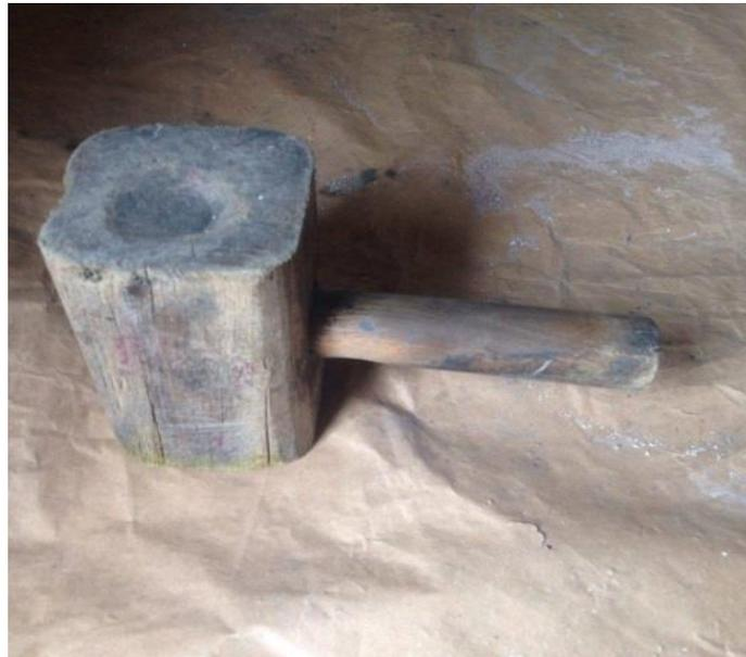
**Ilustración 44 Maso de Madera usado en el Traqueo de Materiales Fuente: Autor**
