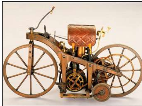
Figura 2.2. Motocicleta con motor de combustión interna de 4 tiempos por Daimler Einspur en 1885. Fuente: (Escobar, 2012)
