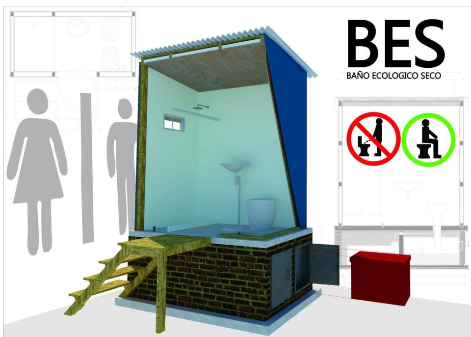
Figura 65: Diseño del baño ecológico seco
