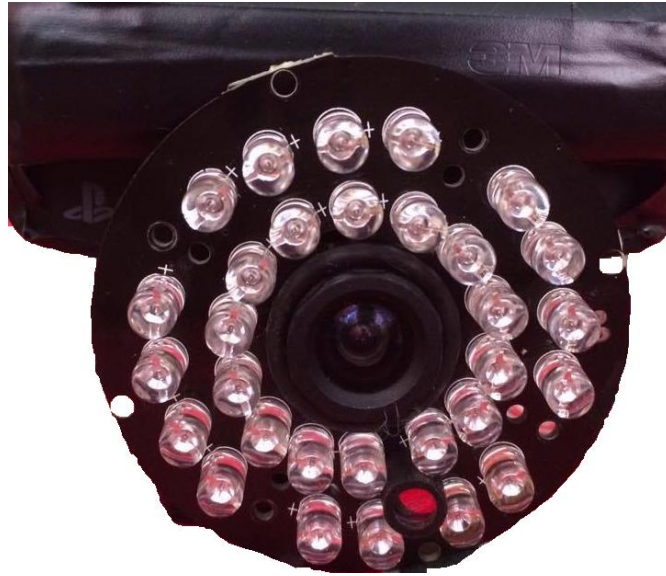
Figura 3.7. Implementación del arreglo de leds en la cámara.
