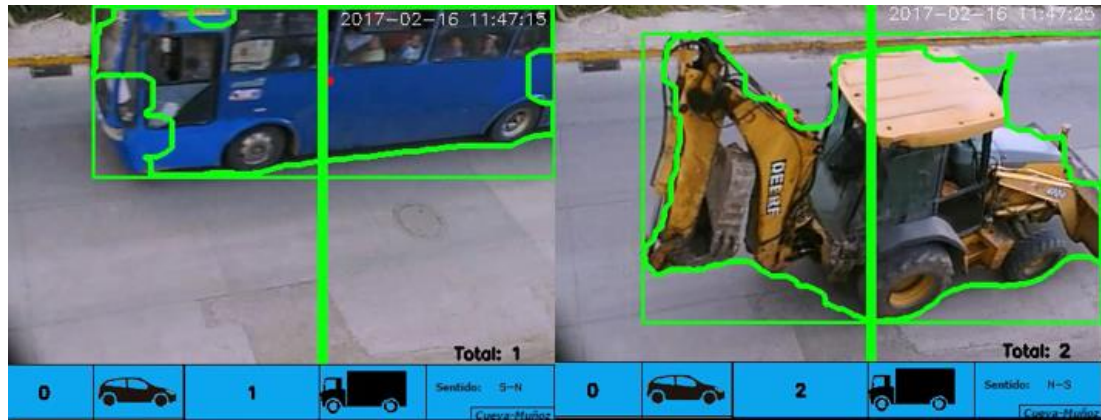
Figura 5.5. Detección de vehículos pesados.
