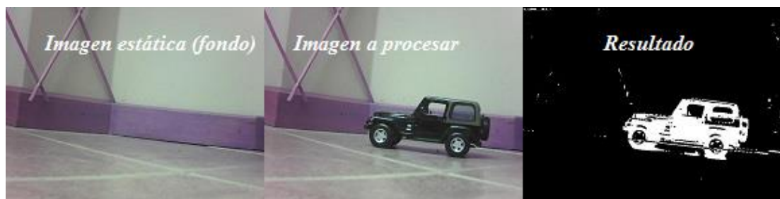
Figura 2.23. Sustracción de fondo ( Background subtraction ).
