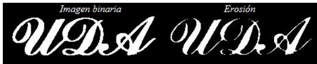
Figura 2.14. Operación morfológica: Erosión.
