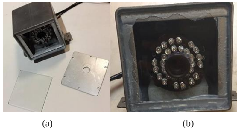
Figura 4.1. (a) Estructura para la cámara. (b) Cámara hermetizada.
