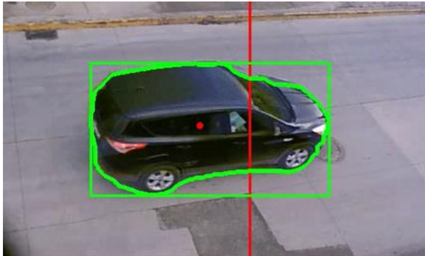
Figura 4.19. Centroide, dibujo de borde y rectángulo alrededor del objeto.
