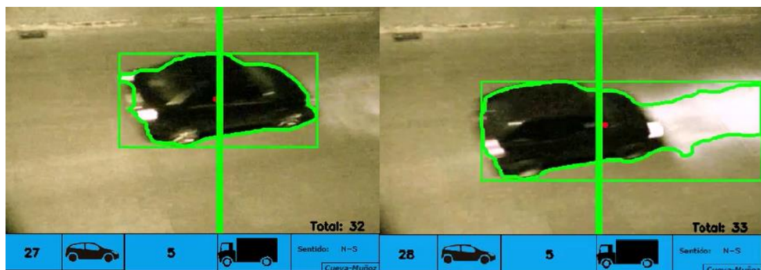
Figura 5.4. Detección vehicular en horario nocturno.
