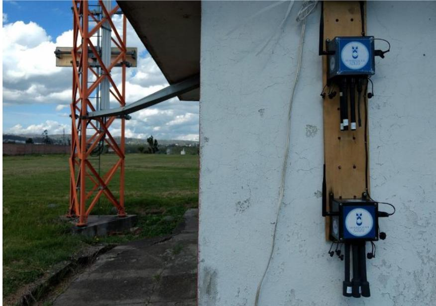
Figura 4.13: Disposición de los nodos sensores junto a la estación AWOS.
