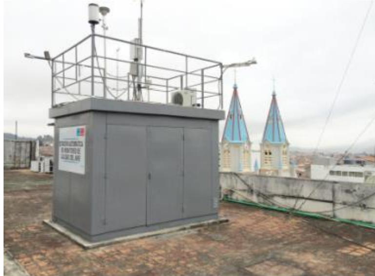
Figura 1.1: Estación automática para el monitoreo de calidad del aire localizada en el Municipio (estación MUN en Figura 1.2).
