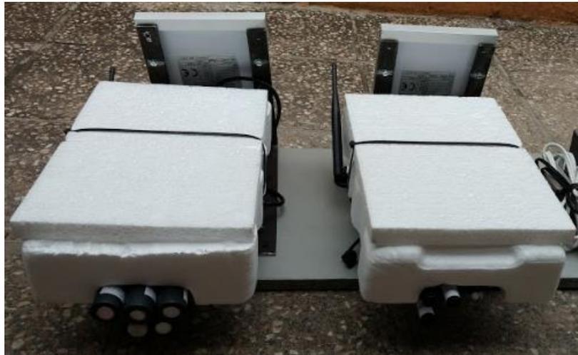
Figura 4.9: Equipos con cobertura de poliestireno expandido, vista inferior.
