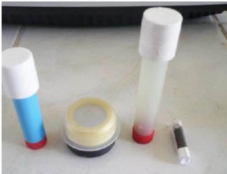
Figura 1.3: Dispositivos empleados en el muestreo pasivo de contaminantes gaseosos.
