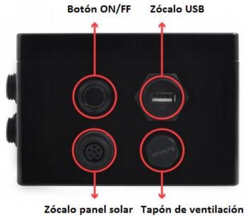
Figura 3.11: Lado de control de la carcasa.
