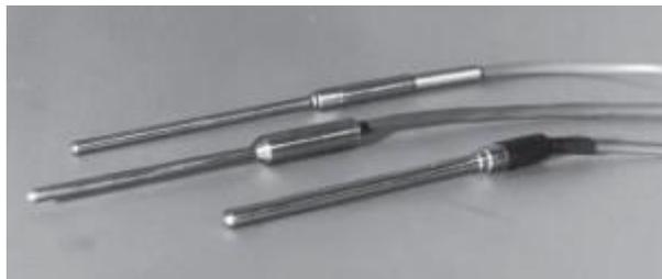
Figura 3.7: Sondas de temperatura series 4470 y 4480 de un AWOS.
