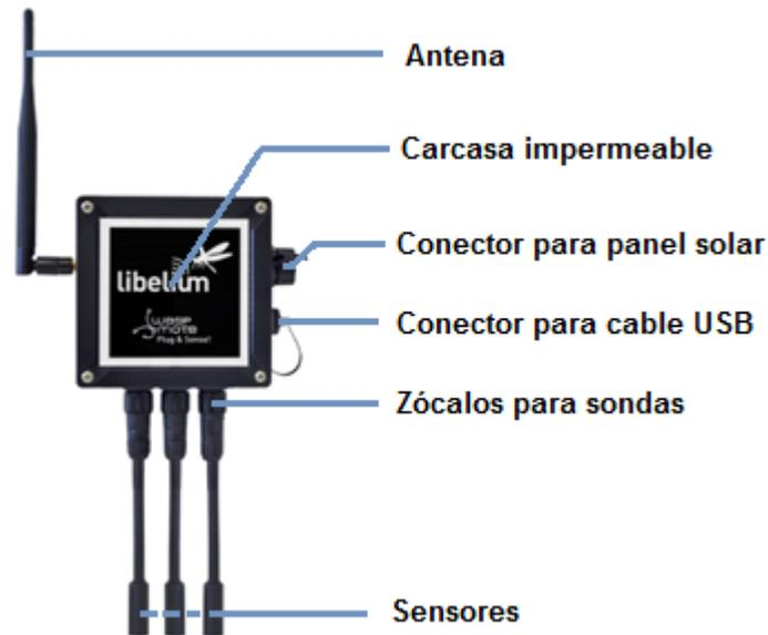
Figura 3.10: Nodo Wasmote Plug &amp; Sense.
