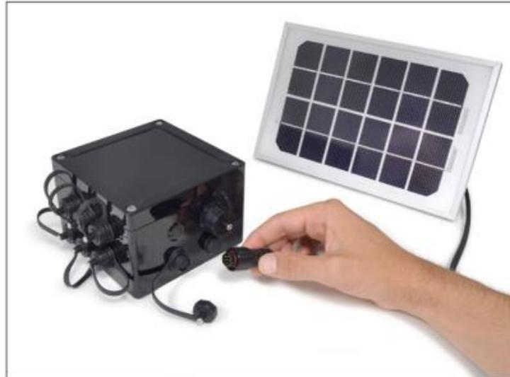
Figura 3.27: Conexión el panel solar al nodo Waspote (Libelium, 2016).
