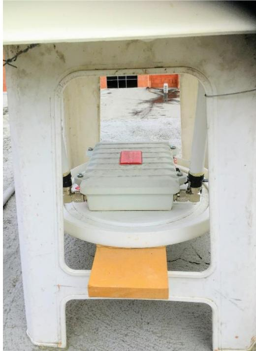
Figura 3.36: Montaje de *gateway* meshlium.
