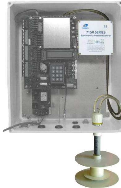
Figura 3.9: Barómetro digital de un AWOS.
