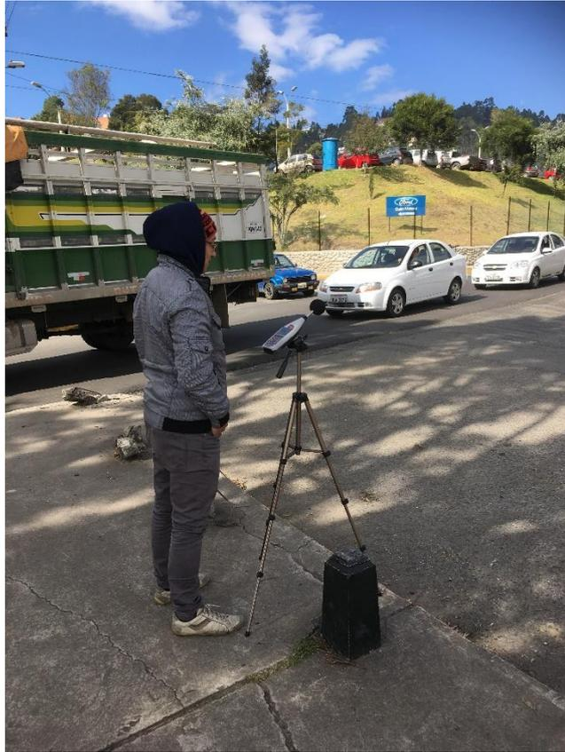
Figura 1.4: Operador de sonómetro en proceso de medición.
