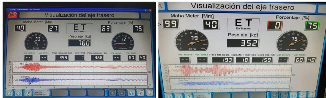
Figura 4.6. Valores de suspensión en buen estado y defectuoso.
