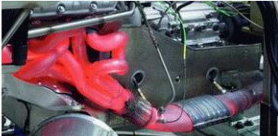
Figura 2.79. Sistema de escape BMW M3.
