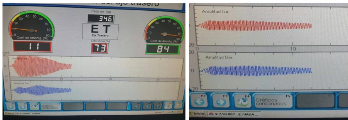
Figura 4.5. Ondas y valores de suspensión defectuosa.
