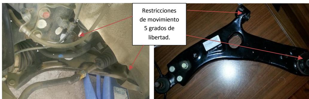
**Figura 3.12.** Restricciones del movimiento de brazo oscilante con bastidor.
