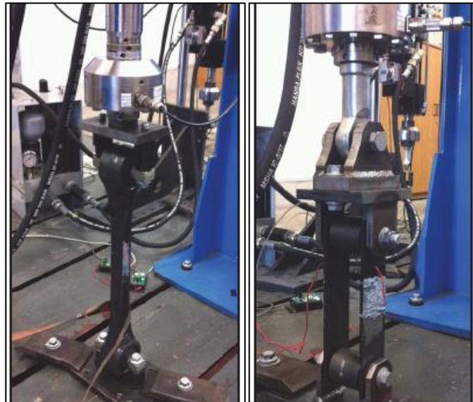
**Figura 1.5** Prueba de tensión en barra y grillete respectivamente.
