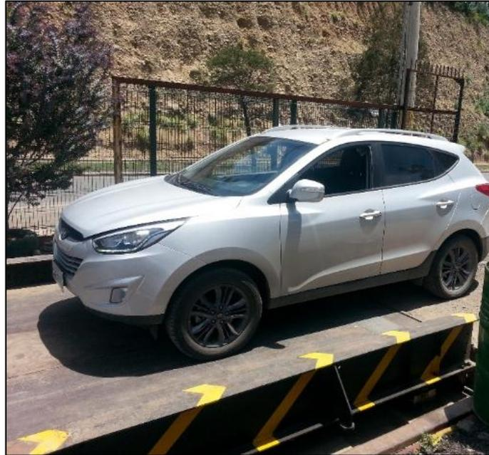
**Figura 2.18.** Análisis y determinación de peso en suspensión delantera.
