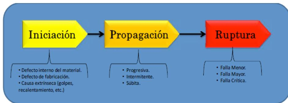
Fig.2- 1 Esquema de evolución de una falla
