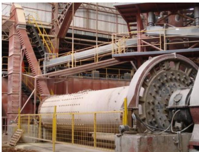
*Fig.2- 4 Molino rotativo de Bolas*
