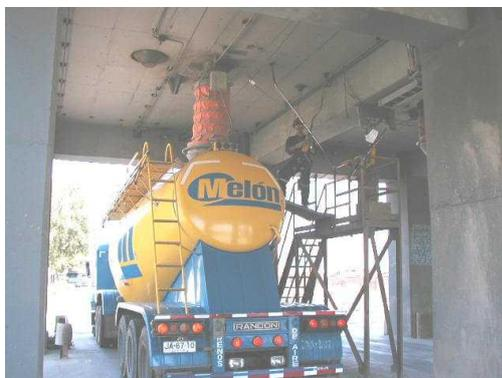
*Fig.1- 13 Silo de despacho a Granel Capacidad 80 Ton/h.*
