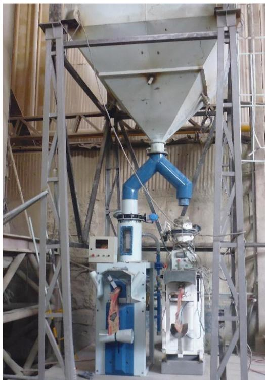
*Fig.2- 6 Línea de Ensacadora Neumática*
