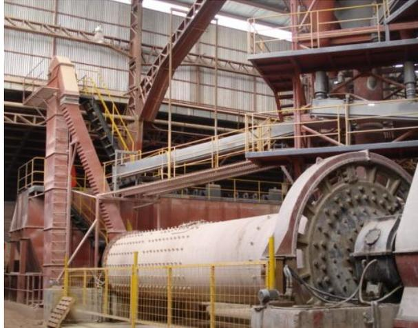
*Fig.1- 10 Molido y clasificación de cemento en molino de bolas Capacidad: 7 - 8.5 Ton/h*
