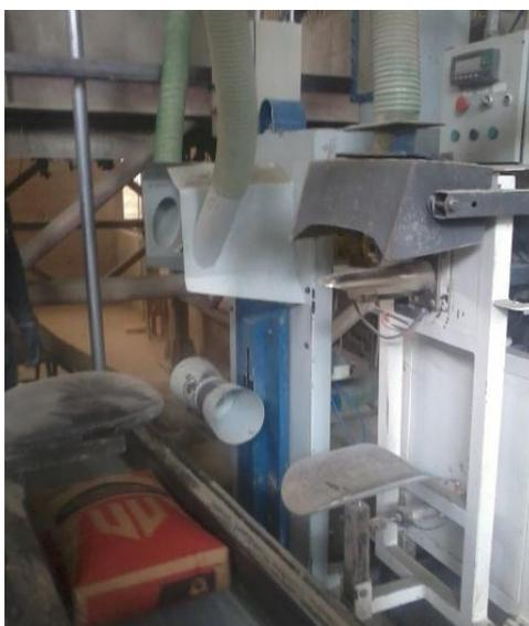
*Fig.1- 12 Ensacadora neumática para sacos de 50 Kg Capacidad 100 sacos/h.*
