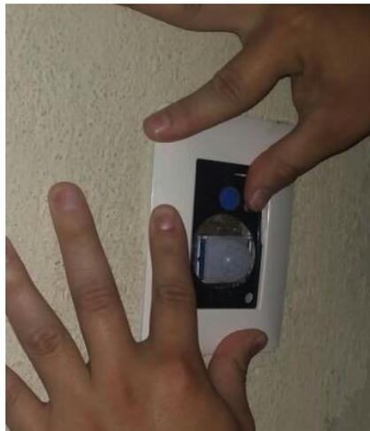
Figura 4.7: Dispositivo multipropósito, sensor presencial e interruptor inteligente.
