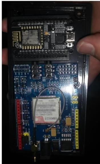
Figura 4.8: Sistema de alarma inteligente.
