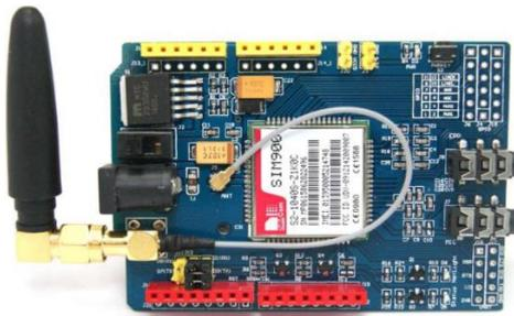
Figura 3.6: Módulo GSM/GPRS SIM900
