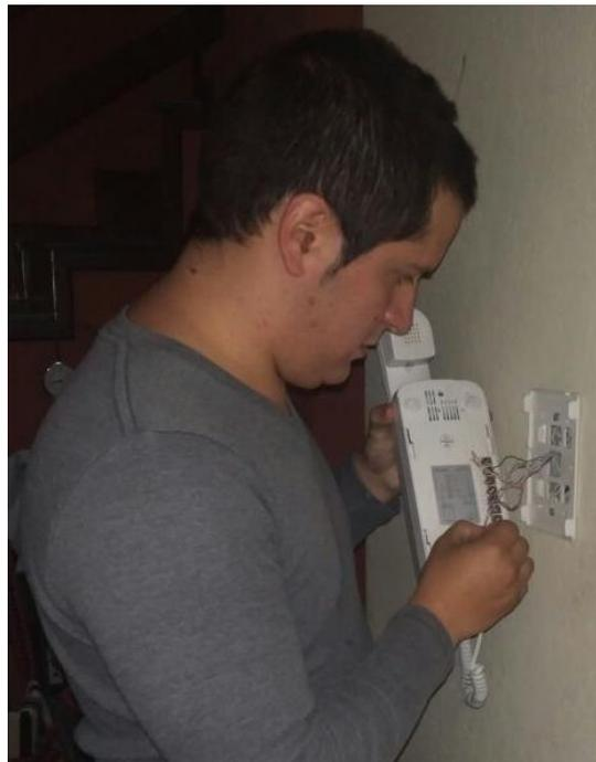
Figura 4.4: Instalación del módulo ESP8266 al portero eléctrico.
