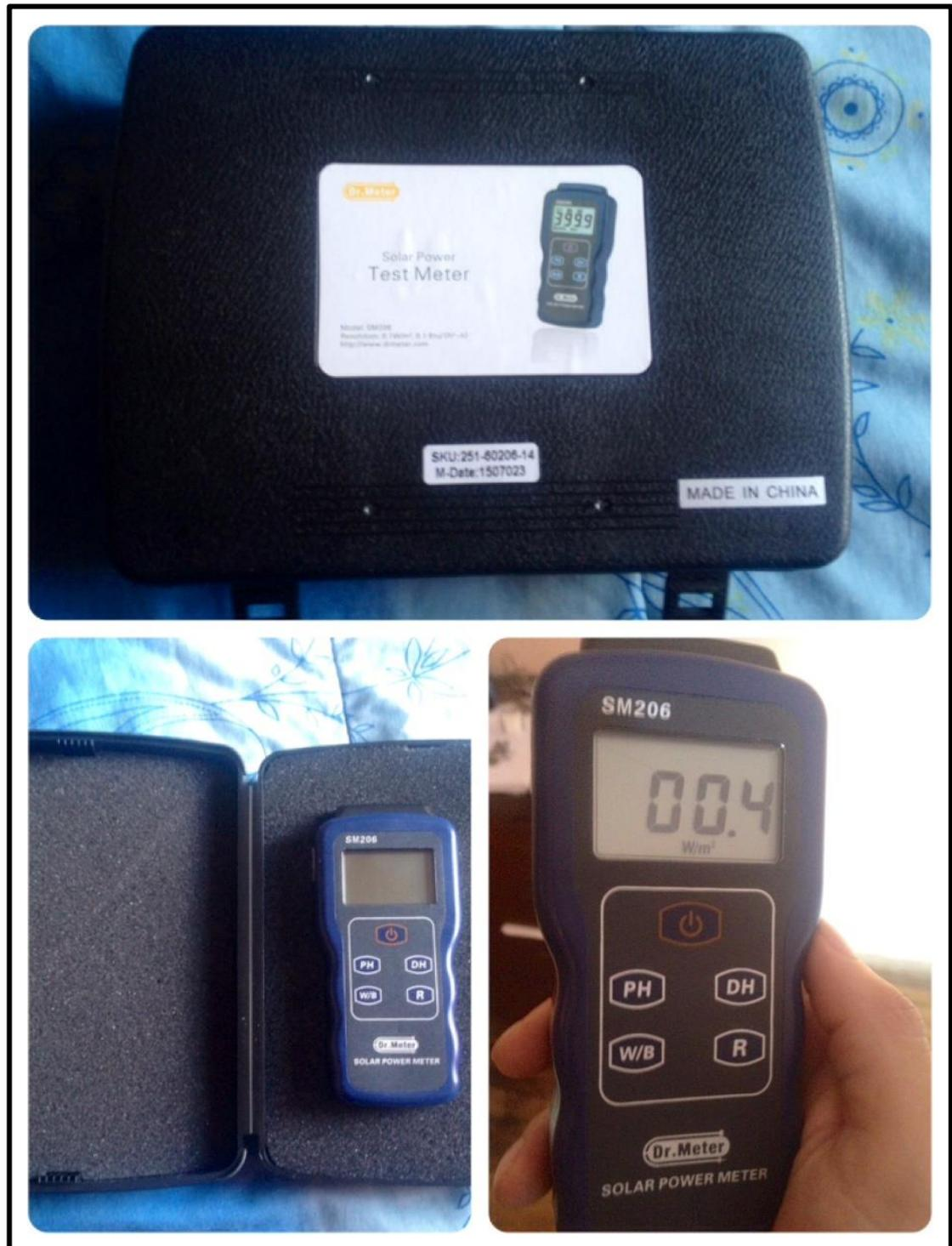
Figura 2.3. Equipo medidor de radiación solar sm206 en su caja y funcionando.
