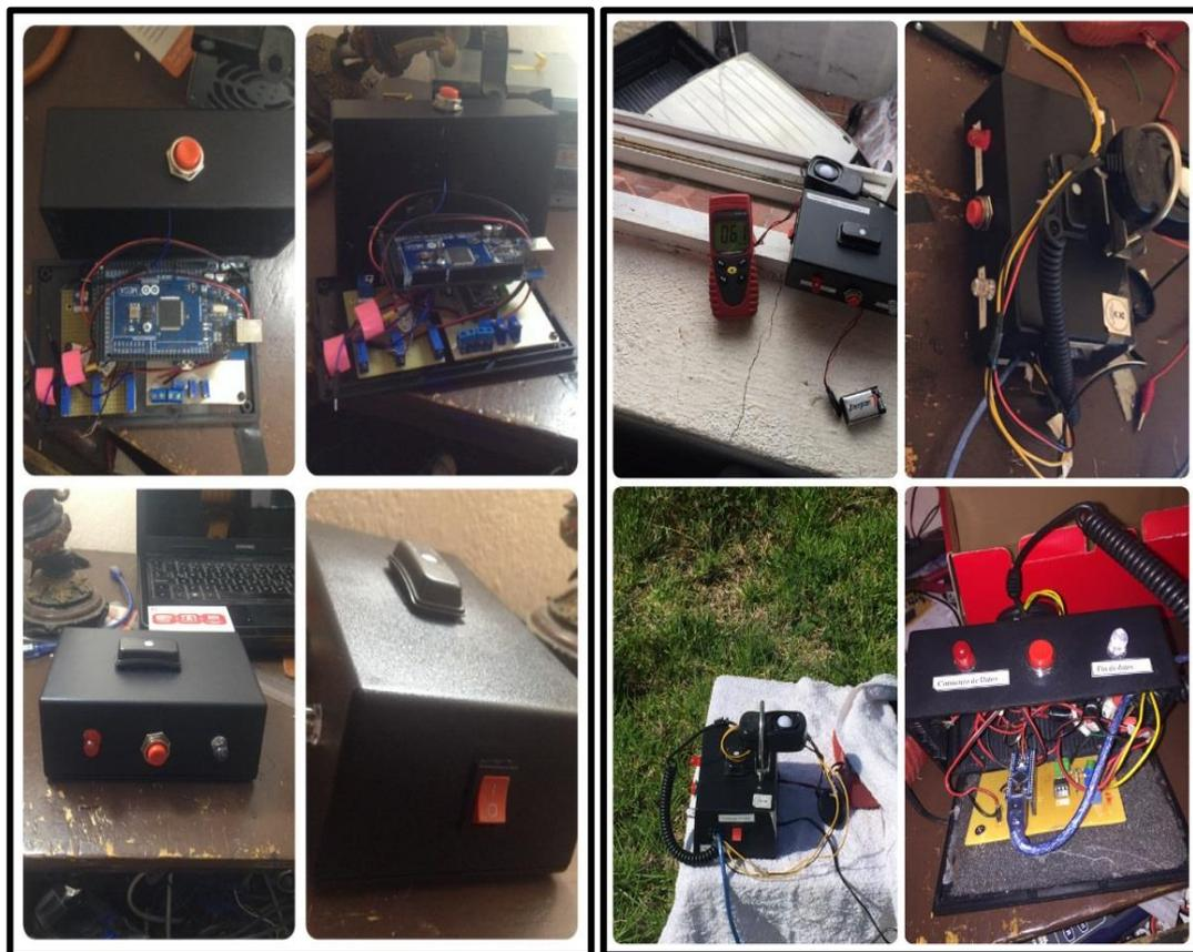
Figura 2.20. Montaje de componentes en la carcasa y puesta en funcionamiento de equipo.
