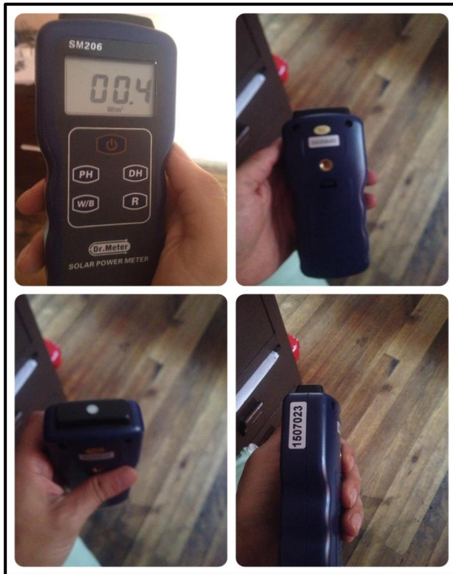
Figura 2.2. Equipo Solar Power Meter SM206 y su sensor de transmisión ubicado en la parte superior del equipo.
