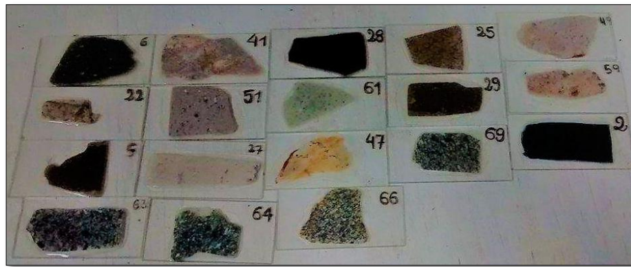
Figura 3.15 Pulido de las muestras a un espesor aproximado de 0.5mm.
