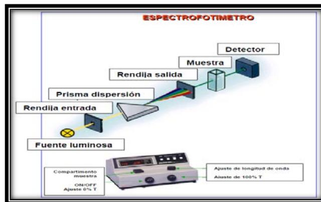
Gráfica N° 1.4: Partes del espectrofotómetro.
