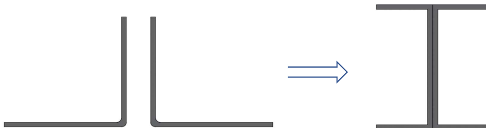
Figura 3.9: Cambio de uni n gen rica en “T” a doble uni n en “I” de dos  ngulos
