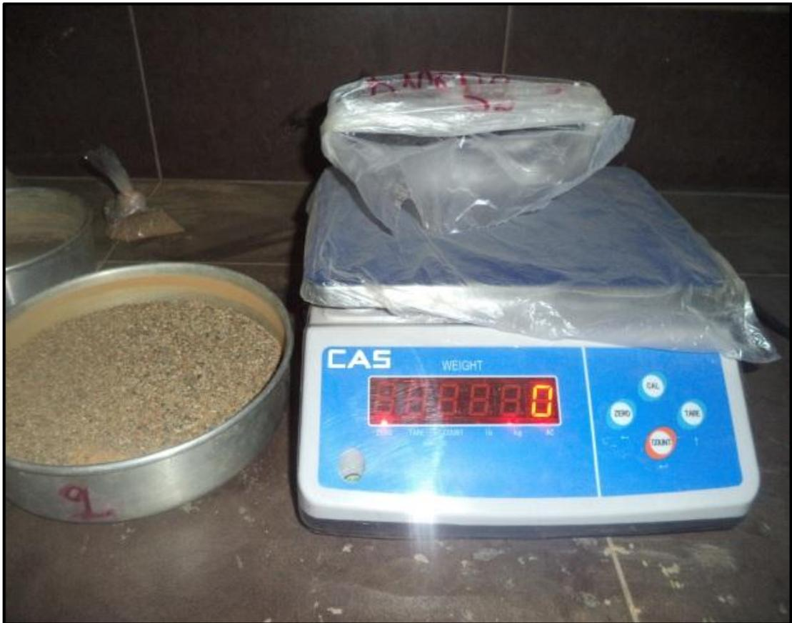
Fotografía 12: Pesado del material seco después del proceso en el equipo
