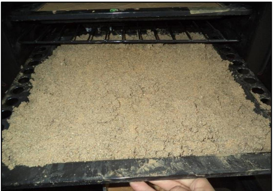
Fotografía 11: Secado del material en horno a 100 °C
