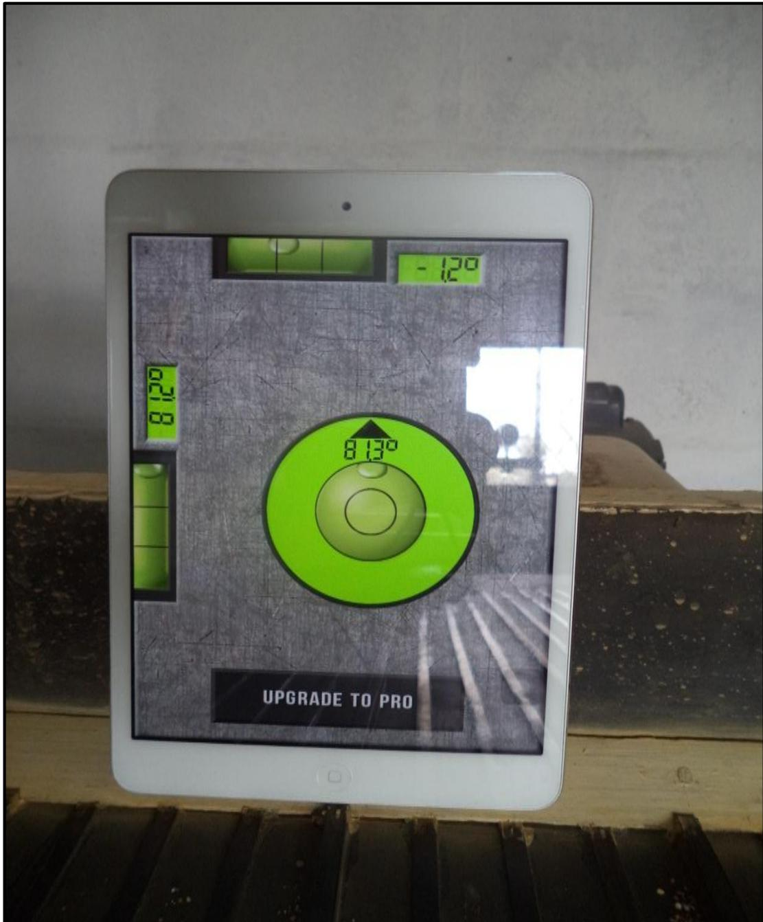
Fotografía 3: Calibración de la mesa vibratoria a 1° de la inclinación transversal
