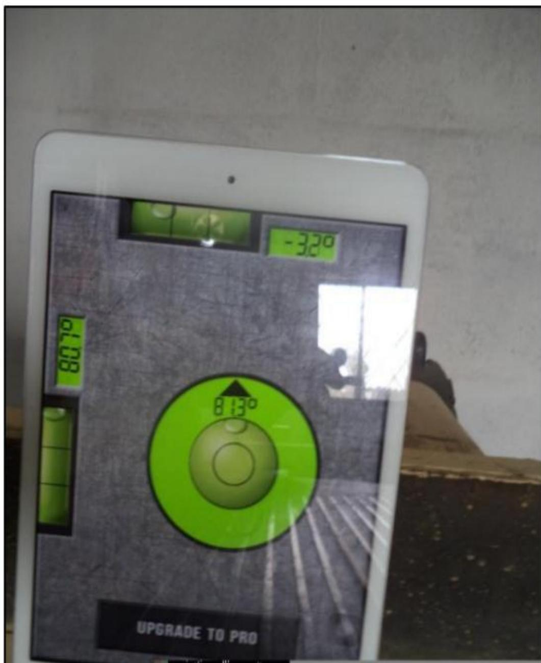
Fotografía 5: Calibración de la mesa vibratoria a 3° de la inclinación transversal
