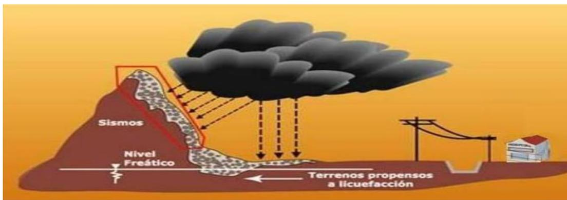
Figura 7: Deslizamientos por saturación del suelo
