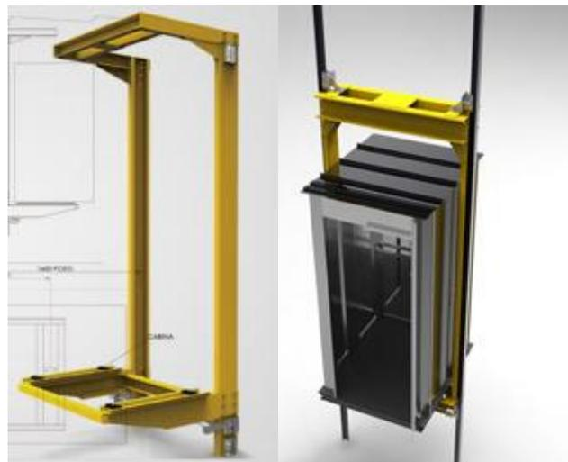
*FIGURA 2 Chasis o Bastidor.*
