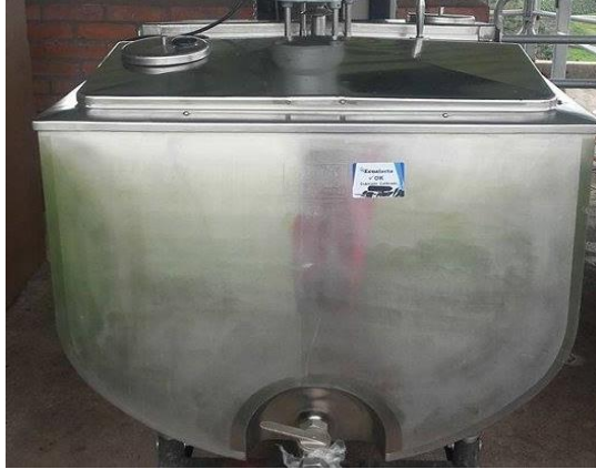
Figura 10: Tanque de enfriamiento de leche cruda
