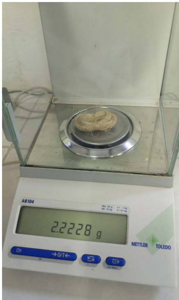
Figura 54: Pesaje de la fibra de ramo de novia (Autoría propia, 2017)
