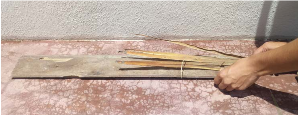
Figura 47: Separación de las hojas en fibras (Autoría propia, 2017)
