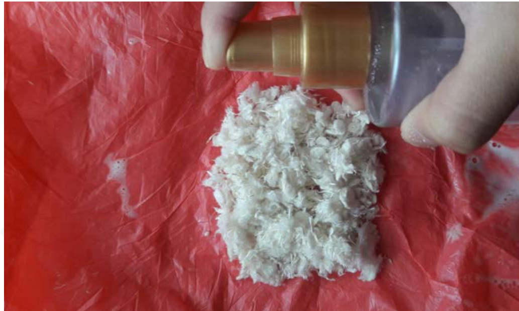
Figura 68: Rociado de agua con jabón en la celulosa (Autoría propia, 2017)
