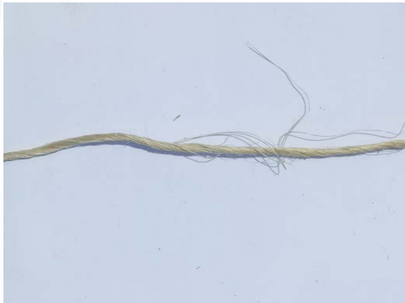
Figura 53: Aplicación de torsión al hilo (Autoría propia, 2017)
