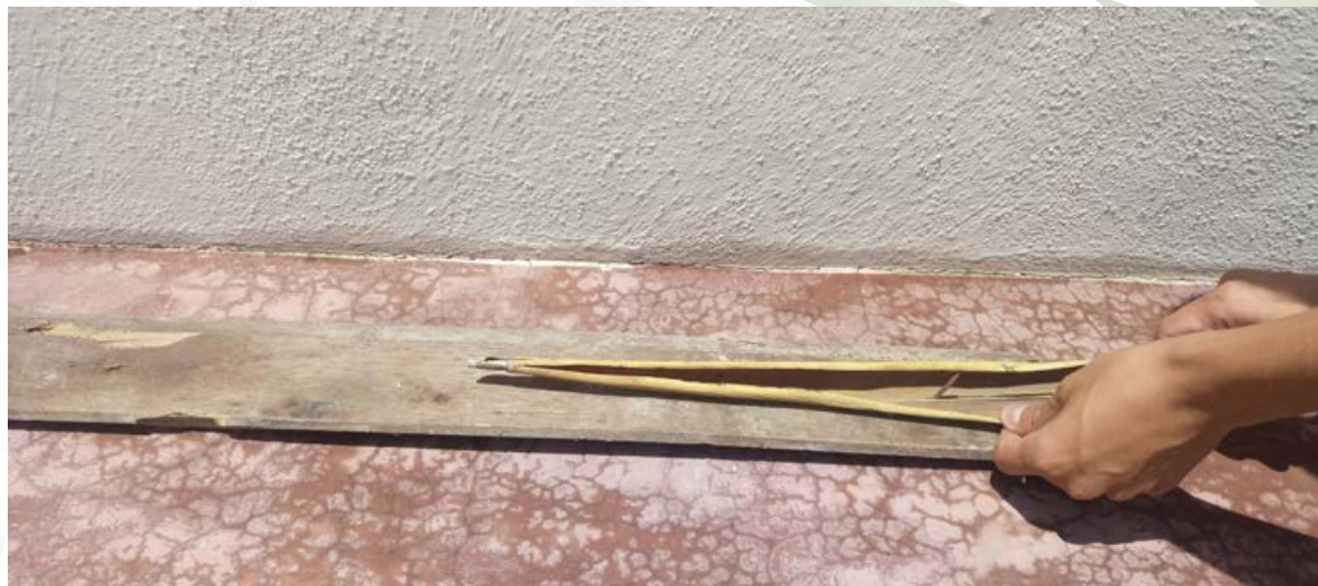
Figura 46: Clavo sujeto a madera para división de hojas (Autoría propia, 2017)
