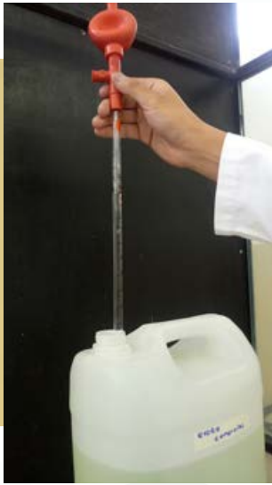
Figura 41: Pipeteo de hipoclorito de sodio (Autoría propia, 2017)
