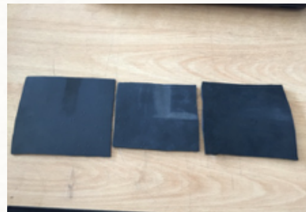
Fig. 49 Los tres tipos de lámina de caucho de shore: 65, 75 y 85.
