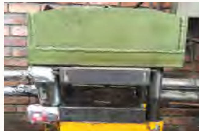
Fig. 45 La prensa que vulcaniza: Prensa hidráulica con fluido de aceite térmico.
