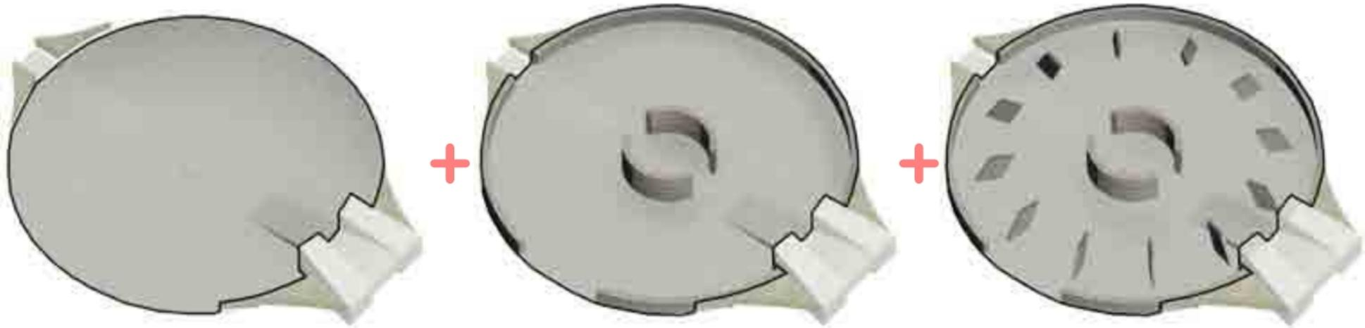
1. Losa de piso 2. Muro de contención y diafragma central
