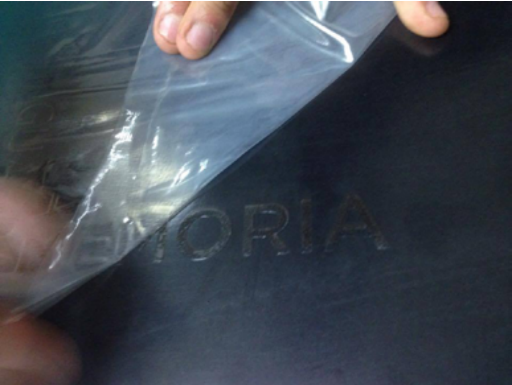
Figura 44. Transferencia de adhesivo.
