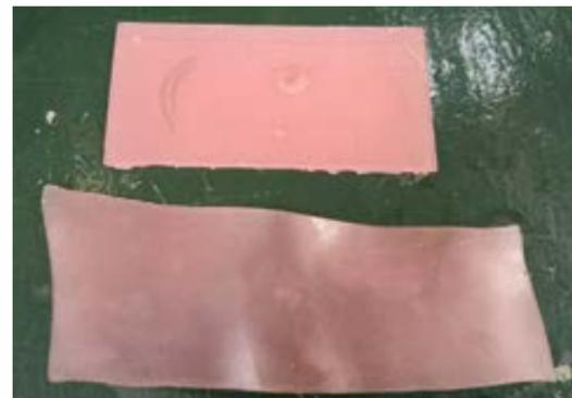
Imagen # 46 - Lámina de cera original y lámina de cera laminada
