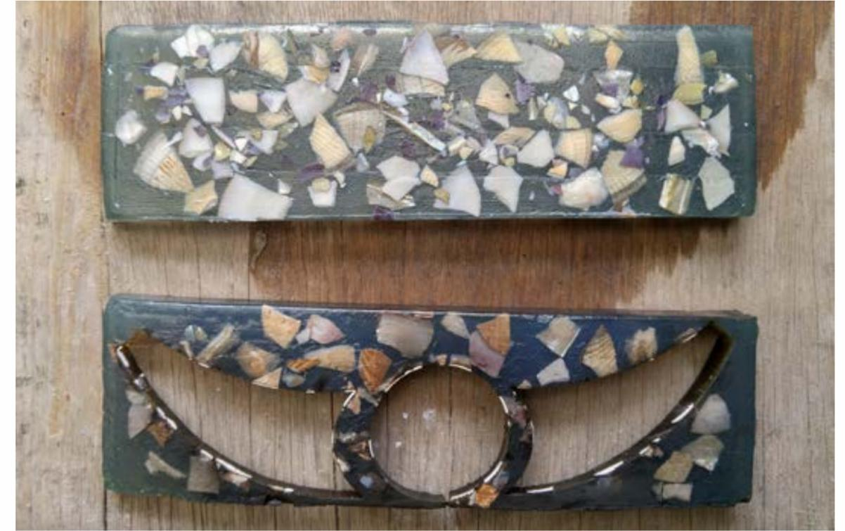
Imagen # 56 - Muestra de corte en laser
