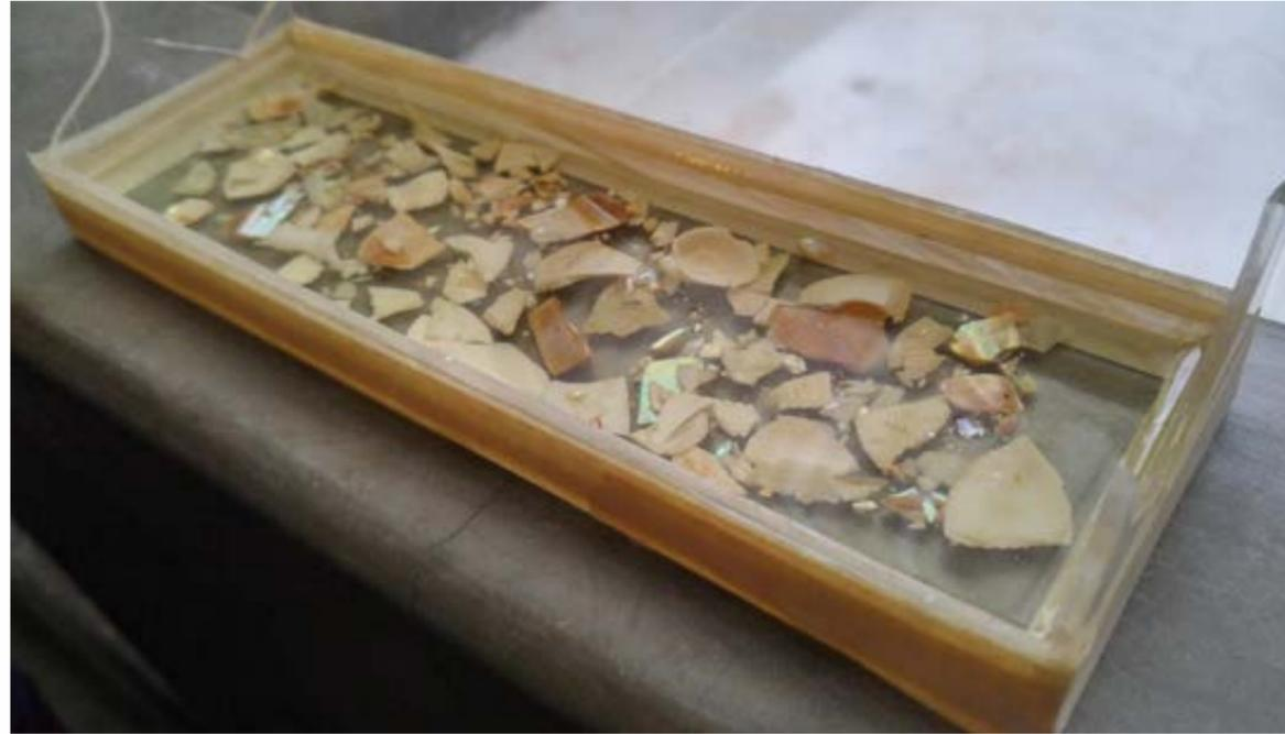
Imagen # 54 - Secado de resina en molde
