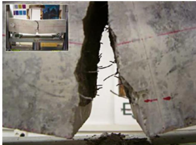
El proyecto implementa fibras de acero que tiene una dimensión de 50mm de largo y un radio de 1mm, dichas dimensiones se asemejan a un clip abierto.
