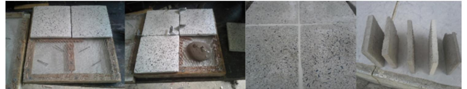
La cara posterior de las placas se observa como sobresalen las limallas reforzando el anclaje de la placa. En comparación con la placa de cerámica de la izquierda tiene un mismo refuerzo para adherencia en la cara en forma cuadricular.
