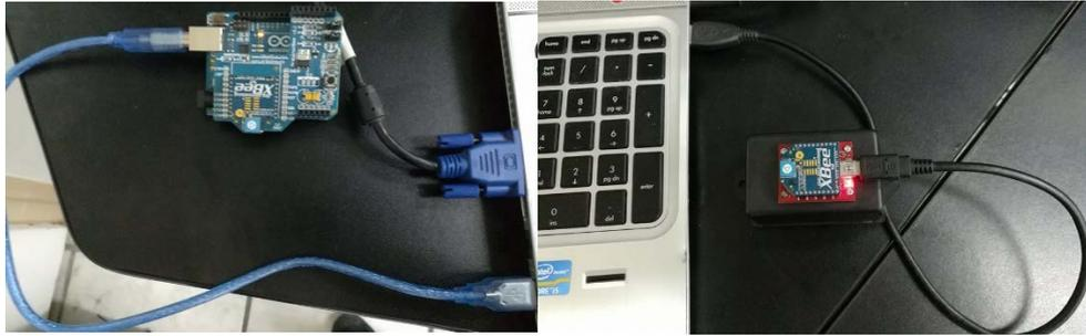
Figura 2.42: Conexión inalámbrica entre PCs mediante módulos Xbee.
