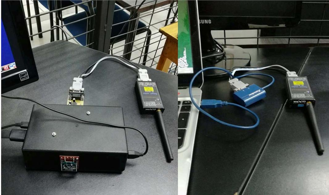
Figura 2.44: Conexión inalámbrica PcDuino y PC.
