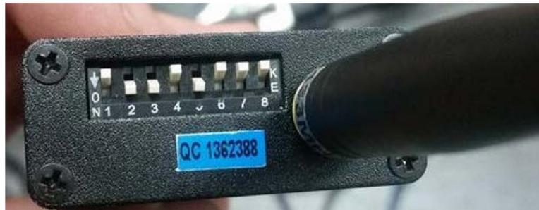
Figura 2.10: Pines de configuración Radio UM96/M1.
