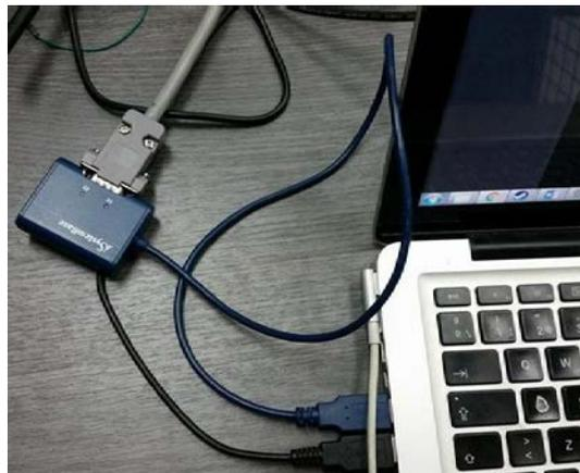
Figura 2. 32: Conexión cable USB-rs232 PC1.
