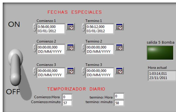
Figura 2.23. Temporizador de encendido de sistema de control de agua.
