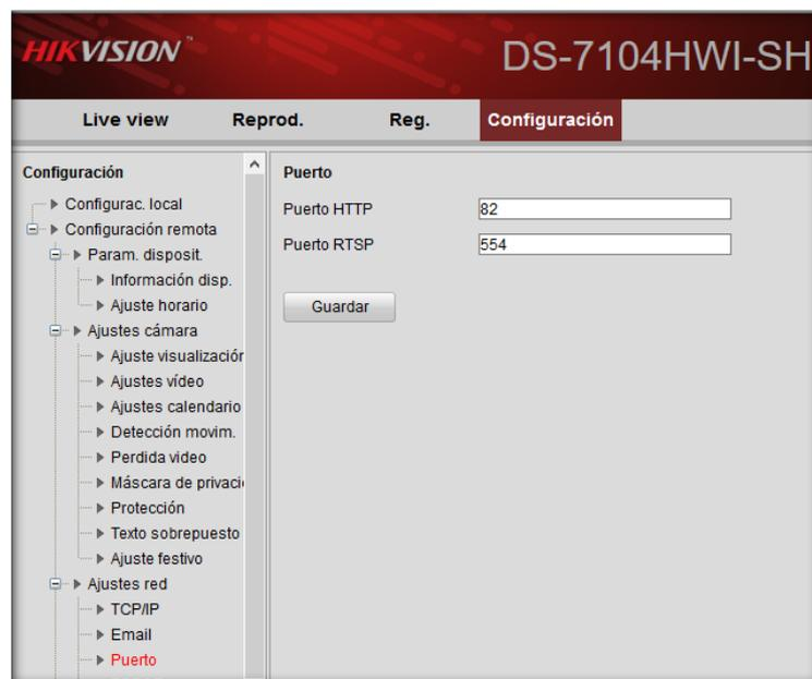
Figura 3.31. Configuración puertos de HTTP y RSTP (*streaming* de video).
