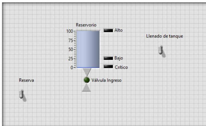
Figura 2.22. Panel frontal de sistema de control de agua.
