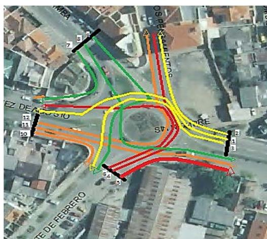
Figura 2-18 Esquema de flujos en intersección 8
