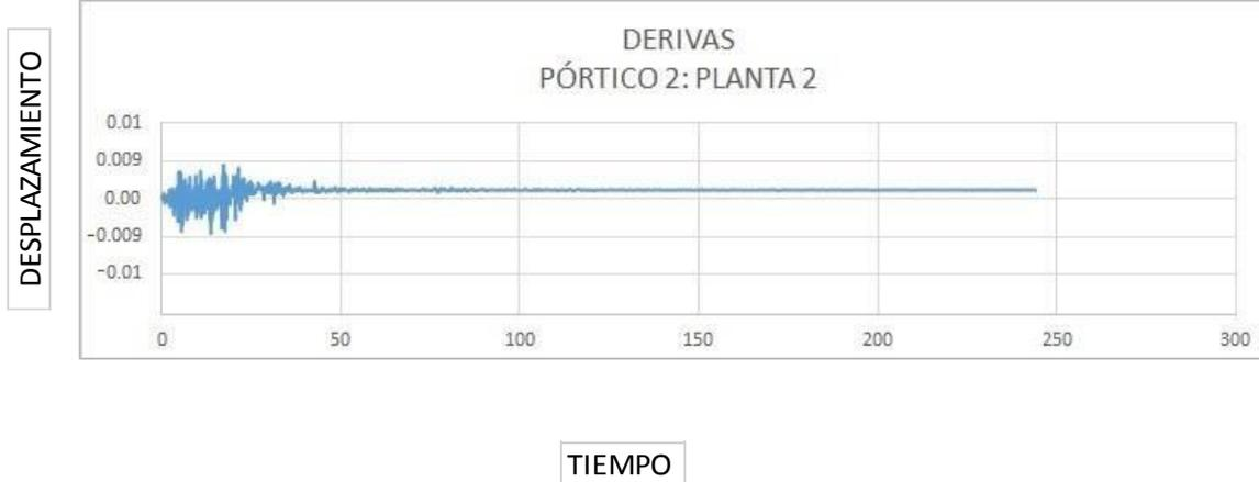
Figura 2.4.4.8 derivas inelásticas del pórtico 2, segunda planta. Sismo ACHN-E (T = 2500 años)
