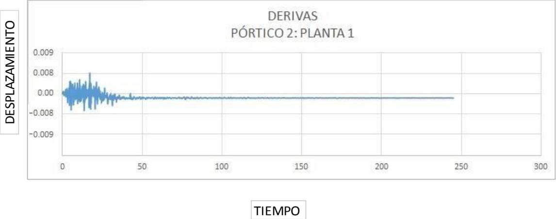
Figura 2.4.4.7 derivas inelásticas del pórtico 2, primera planta. Sismo ACHN-E (T = 2500 años)
