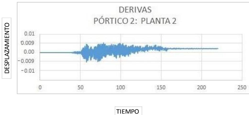
Figura 2.4.4.12 derivas inelásticas del pórtico 2, segunda planta. Sismo AES2-E (T = 2500 años)
