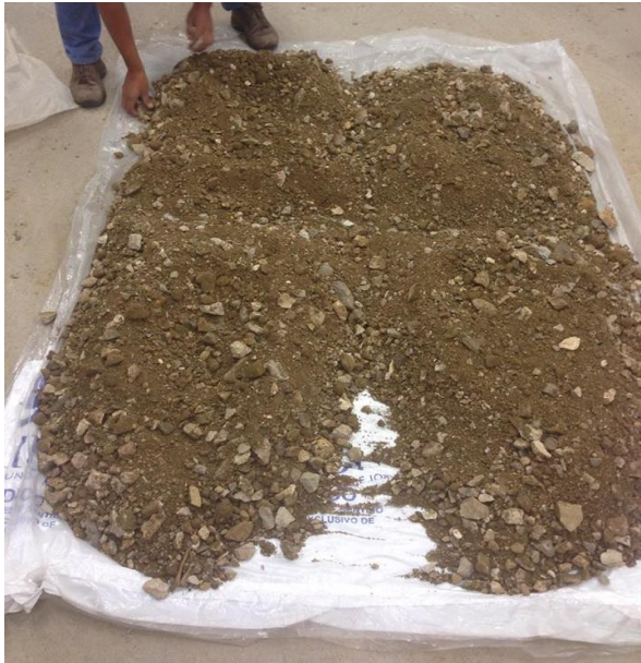
Figura 3.3 Tendido de mix.
