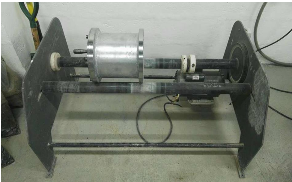
Figura 3.12 Molino de bolas de acero en funcionamiento.
