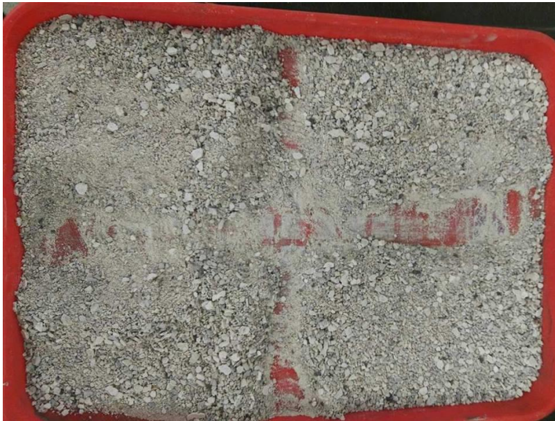
Figura 3.7 Método de cuarteo, material caliza.
