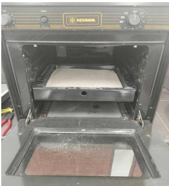
Figura 3.8 Secado del material en el horno.
