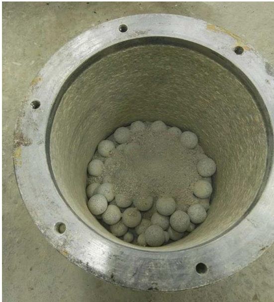
Figura 3.11 Molino con bolas de acero y material.
