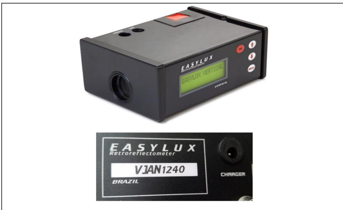
**Figura 3.34 Modelo de Retroreflectómetro vertical.**
