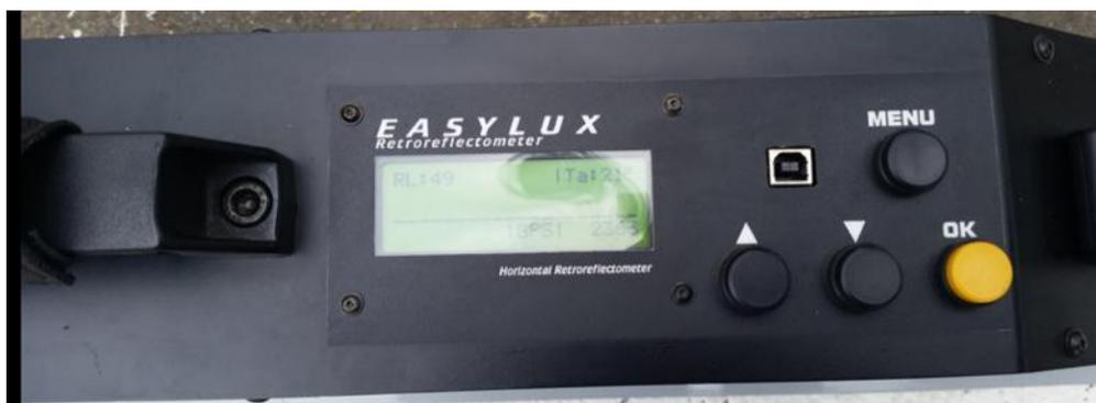
**Figura 3.37** Modelo de retroreflectómetro horizontal utilizado.
