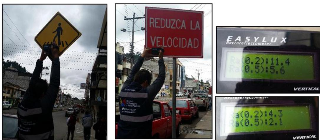
**Figura 3.35 Medición de las señales verticales.**
