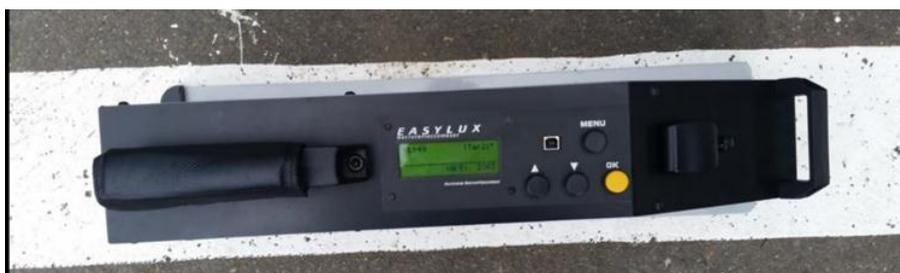
**Figura 3.38** *Medición con retroreflectómetro horizontal.*
