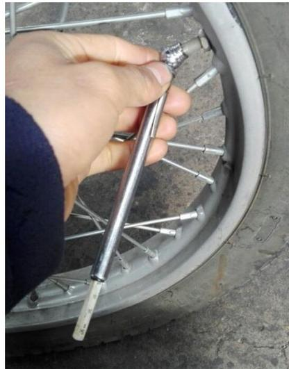
Figura 2.13. Medición de presión de inflado de neumáticos.
