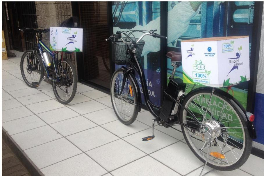
Figura 2.5. Bicicletas eléctricas equipadas con caja para transporte de carga.
