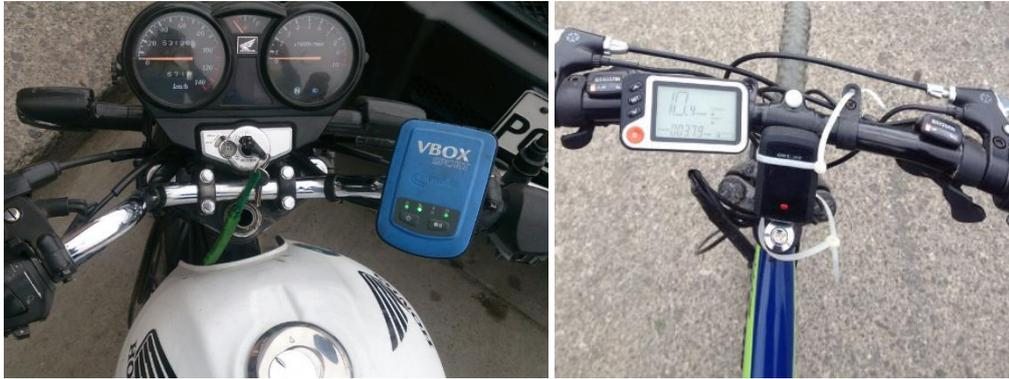
Figura 2.3. Motocicleta y bicicleta eléctrica equipadas con GPS
