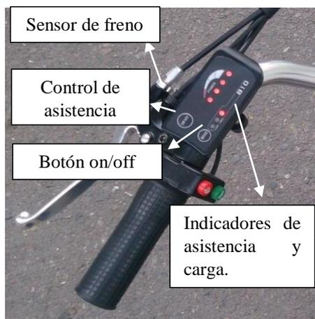
Figura 2.2. Componentes bicicleta eléctrica importada.
