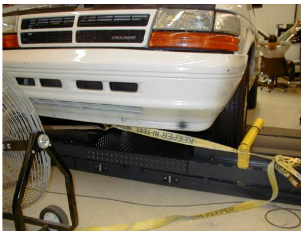
Figura 4.3: Sujeción del vehículo con correas de Seguridad
