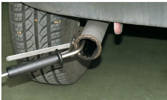
Figura 4.4: Sonda para medición de gases en el tubo de escape de un Vehículo.
