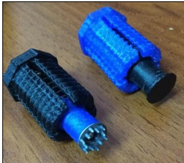
Figura 3.4: Piezas de sujeción de electrodos y de confort.
