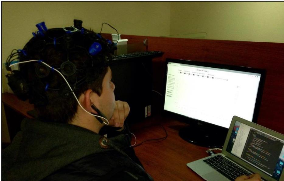
Figura 4.1: Sujeto de prueba durante el registro EEG.
