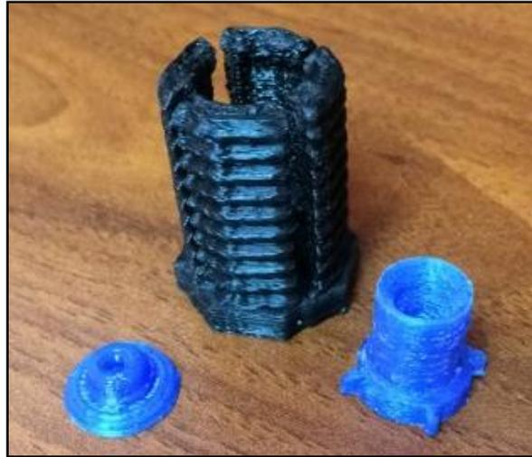
Figura 3.3: Piezas para sujeción y confort de electrodos. De derecha a izquierda: soporte, tornillo y pieza de confort.
