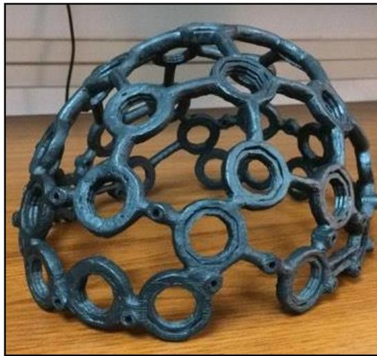
Figura 3.2: Marco del casco de electrodos.
