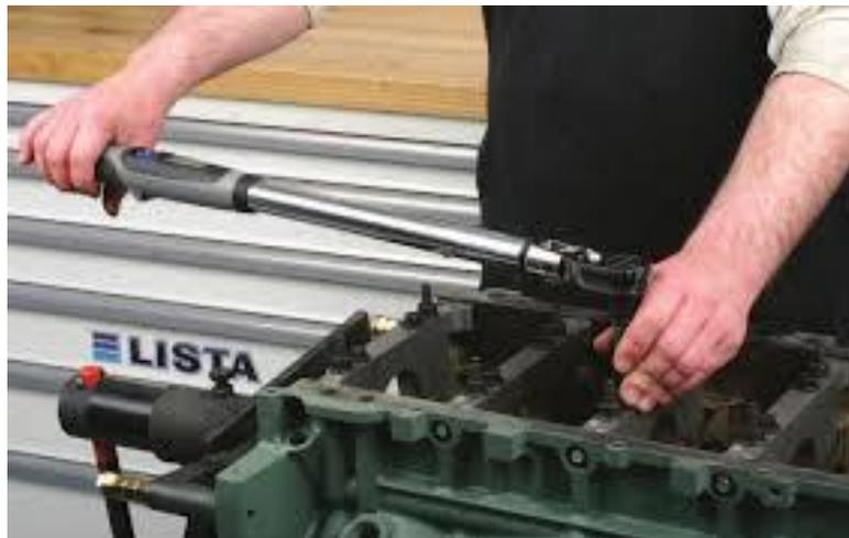
Figura 1. 3: Torquímetro de click
