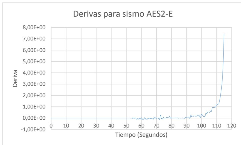
**Figura 2-35:** Derivas de piso de eje aporticado No. 3 para sismo AES2-E.
